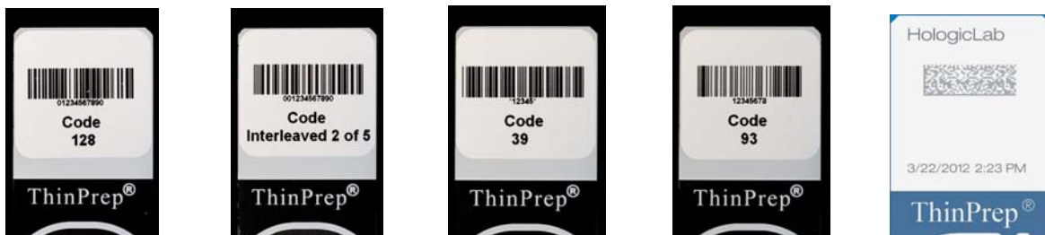
Figura 7-3 Ejemplos de cómo se ajustan los códigos de barras a los portaobjetos ThinPrep
