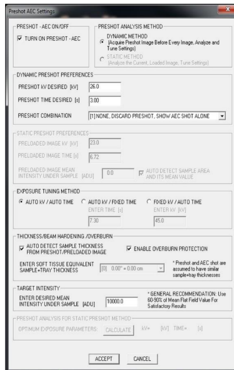
Figura 5.4.20 Caixa de diálogo de Configuração AEC Pré-Captura
