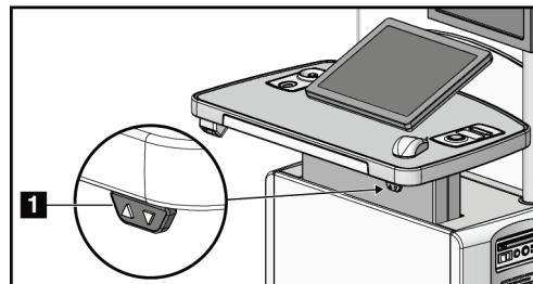
図79: 高さ調節制御パネル
