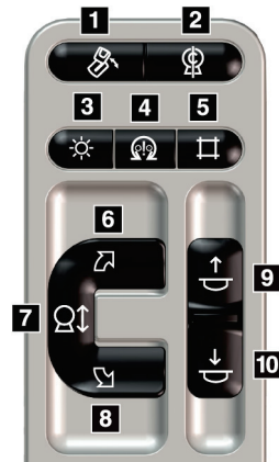
Figura 10: Panel de control del brazo del colimador
