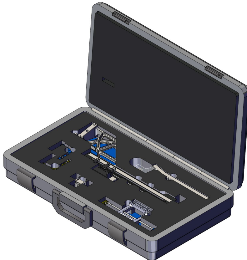
Figure 32 : Bras latéral et mallette de stockage
