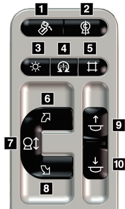
Figura 10: Pannello di controllo del braccio a C
