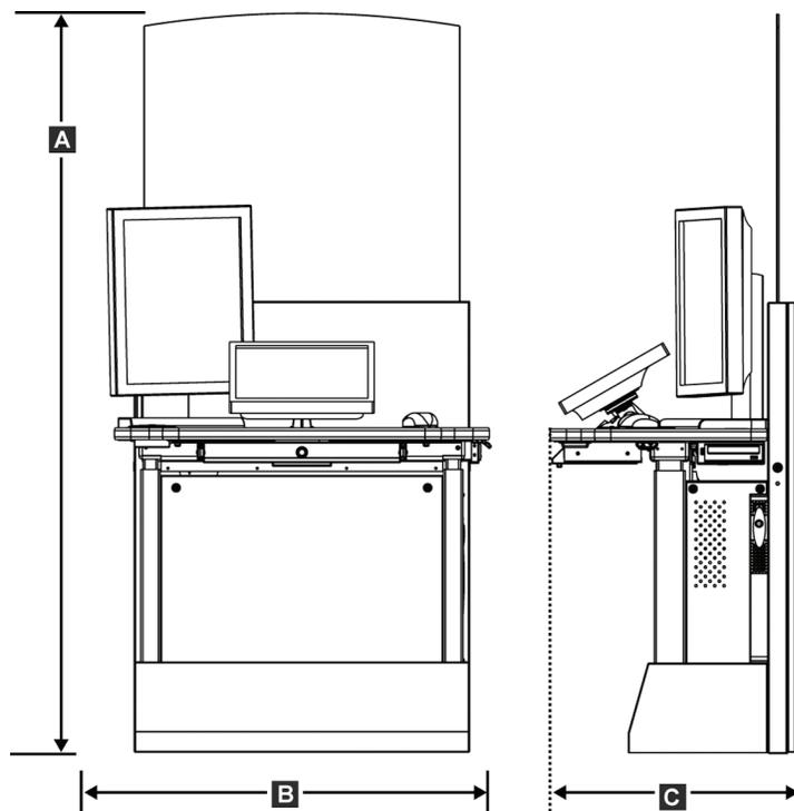
Figura 105: Misure della stazione di acquisizione standard
