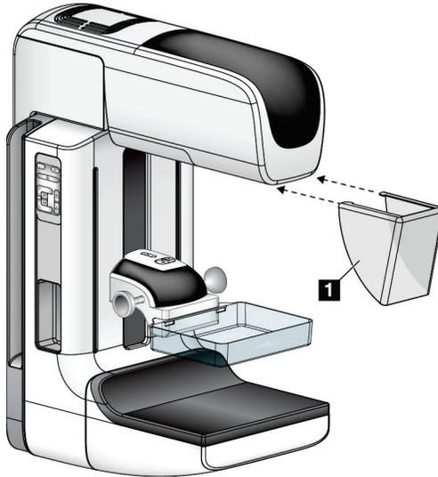
Figura 67: Modalità di installazione dello schermo facciale convenzionale
