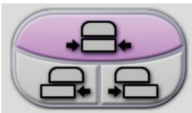
Figura 37: Pulsanti di spostamento della piastra di compressione
