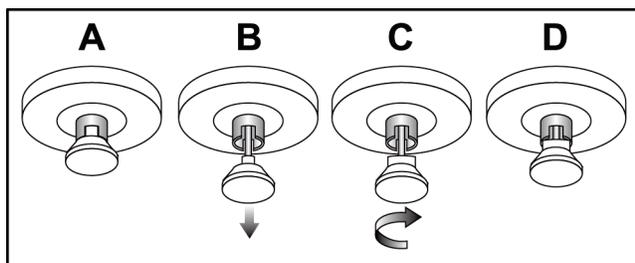
Figura 111: Rilascio del blocco del portatastiera da bloccato (A) a sbloccato (D)
