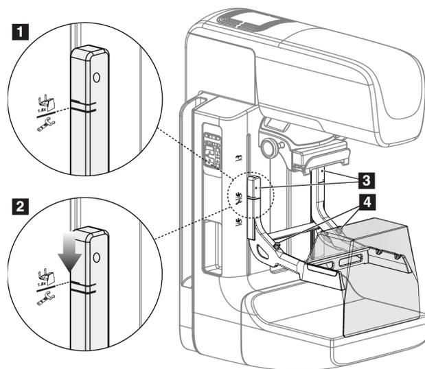
Figura 71: Installazione del piedistallo di ingrandimento
