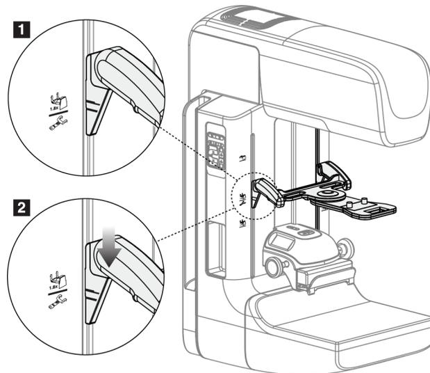
Figura 72: Installazione del mirino di localizzazione
