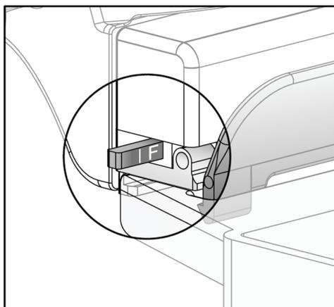
Figura 70: Cursore della modalità di compressione FAST
