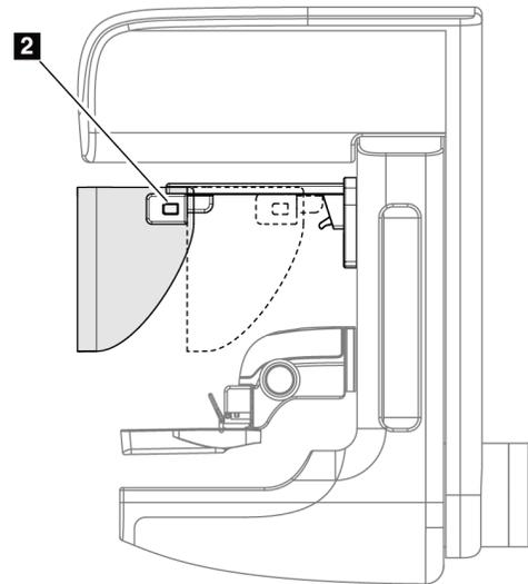
Figura 66: Funzionamento dello schermo facciale
