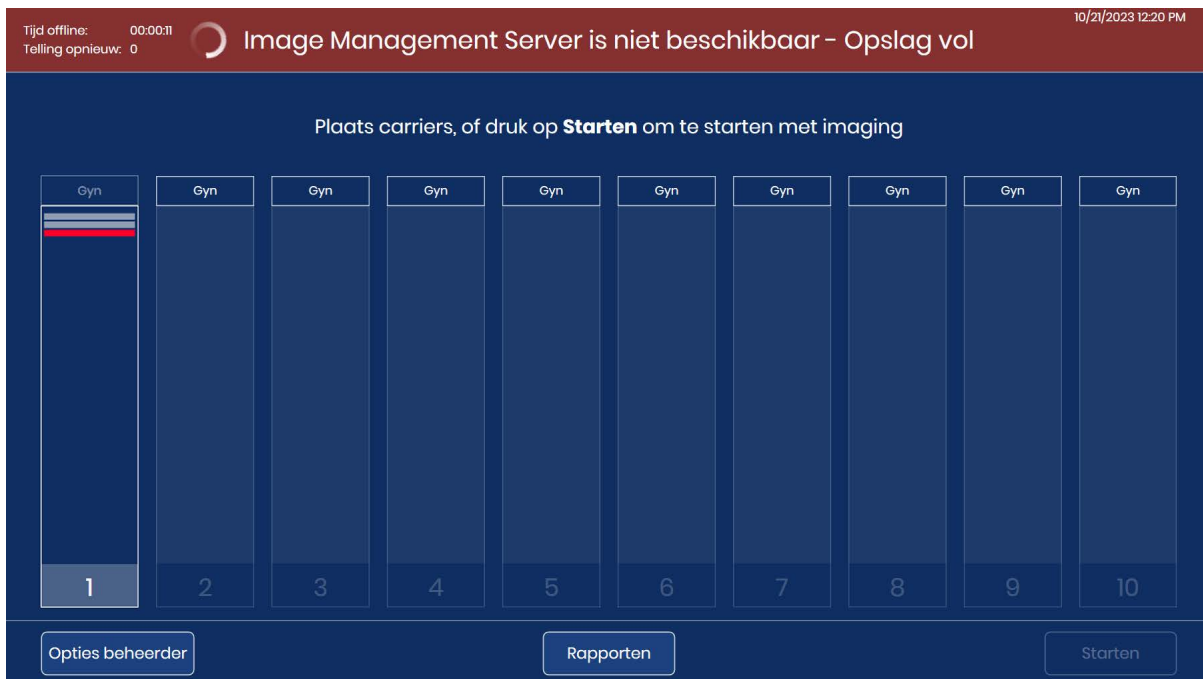
Afbeelding 6-2 Onvoldoende opslagruimte beschikbaar op de image management server
