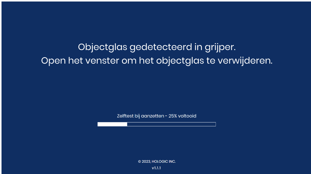
Afbeelding 6-7 Fouterstel met tussenkomst van de gebruiker: Open het venster om het objectglas te verwijderen
