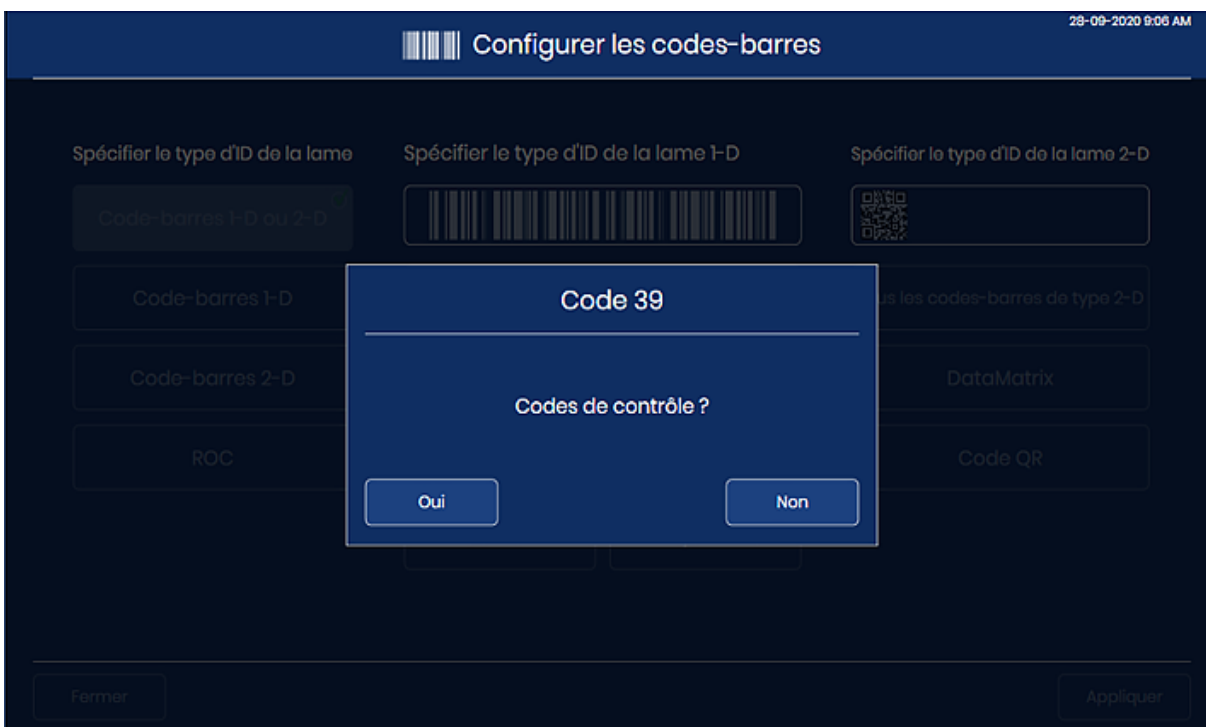
Figure 3-29 Configurer les codes-barres : choisir d'utiliser un code de contrôle pour 2 de 5 entrelacé et Code 39
