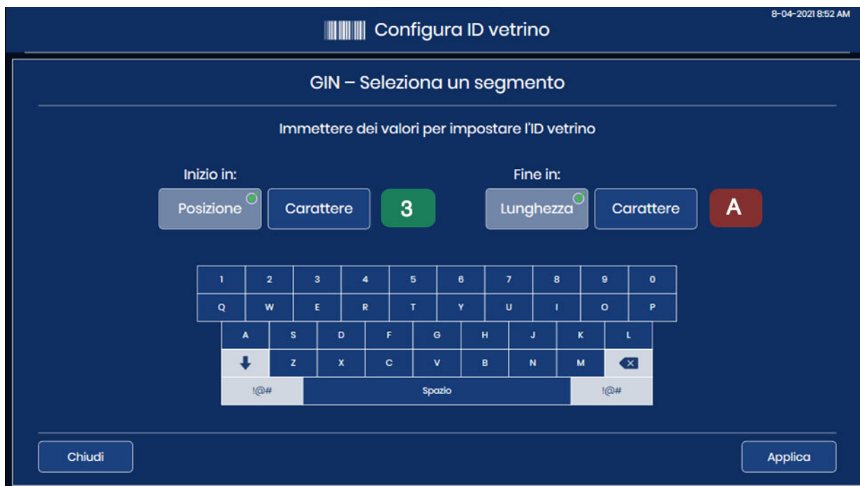
Figura 3-32 Modifica dell'impostazione di Configura ID vetrino: verde per l'immissione valida
