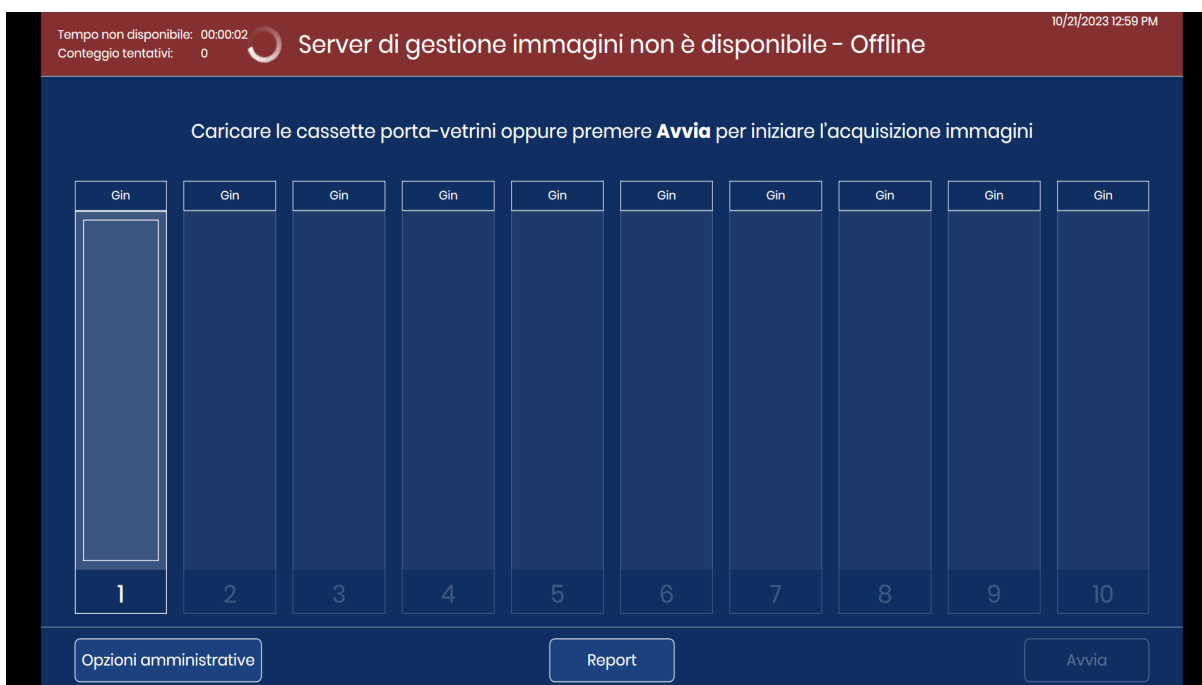
Figura 6-1 Nessun collegamento tra il server di gestione immagini e l'analizzatore di immagini digitali
