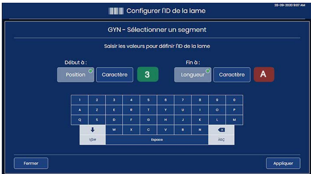
Figure 3-32 Paramètre de modification Configurer l'ID de la lame : vert pour une saisie valide
