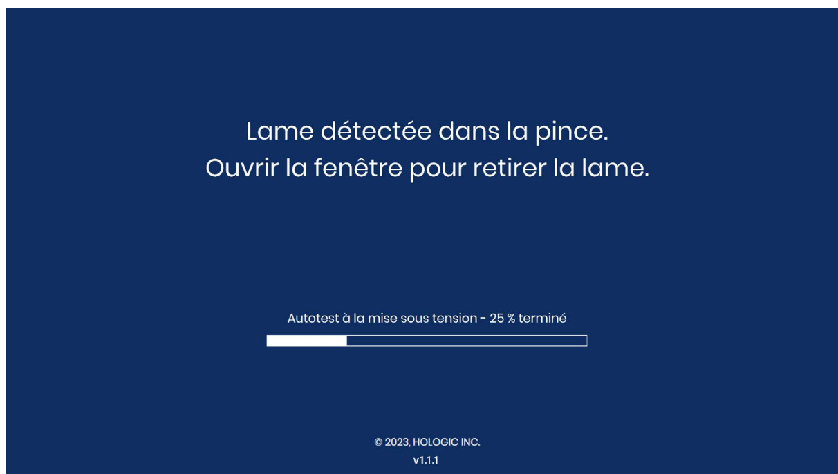
Figure 6-7 Récupération d'une erreur assistée par l'utilisateur : ouvrir la fenêtre pour retirer une lame
