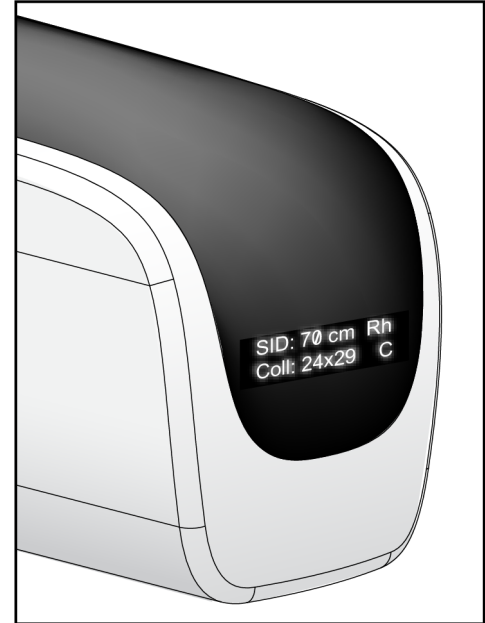
Figur 7: Skærm for rørhoved
