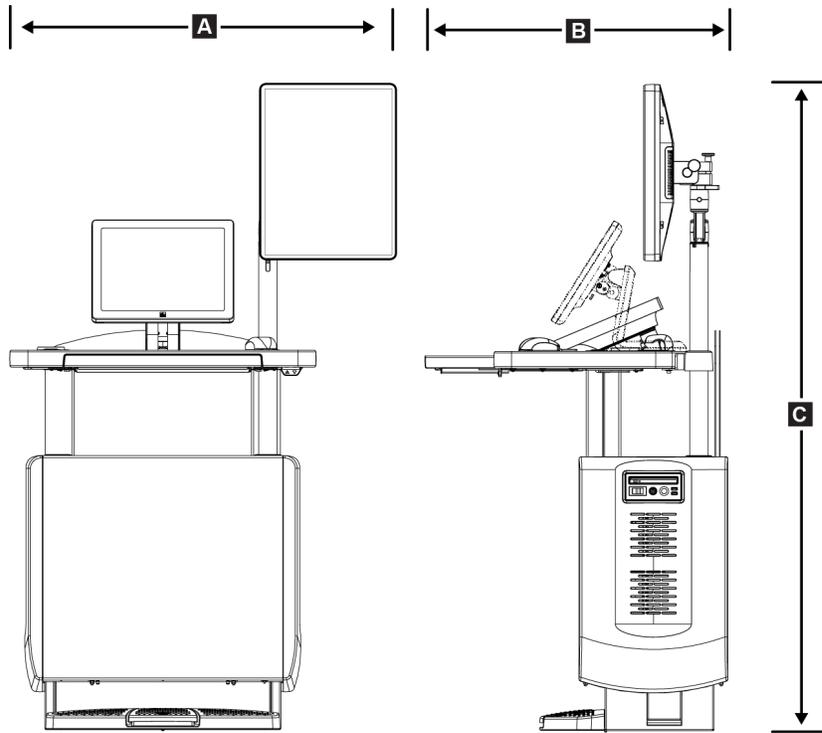
Figura 108: Medidas da estação de trabalho Acquisition universal móvel
