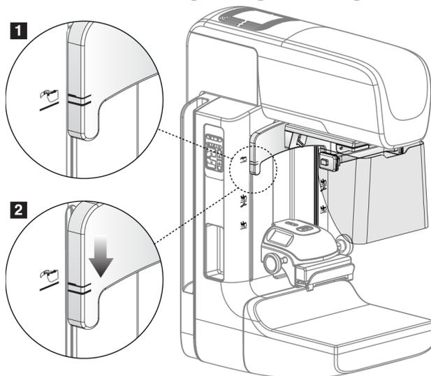
*Figura 66: Como alinhar o protetor de rosto retrátil no braço-C*
