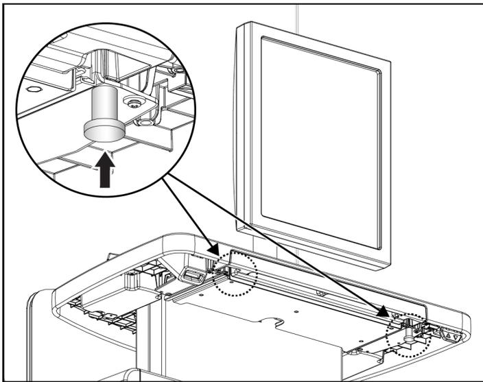
Figura 111: Botão de trava da bandeja do teclado, lado direito ou esquerdo (estação de trabalho de aquisição universal)
