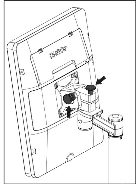
Figura 115: Gire os botões de controle de travamento dos monitores na Estação de Trabalho de Captura Universal Móvel (série II)
