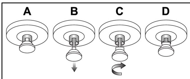
Figura 116: Trava da bandeja liberada de Travada (A) para Destravada (D)
