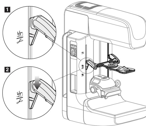
Figura 74: Instalação do dispositivo do retículo de localização
