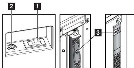
Figura 18: Botões de Força da Estação de trabalho Acquisition Padrão
