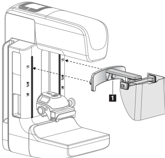
Figura 67: Instalação do protetor de rosto
