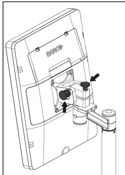
Figura 118: Botões de controle de travamento dos monitores giratórios na estação de trabalho de Aquisição Universal Móvel (série II)
