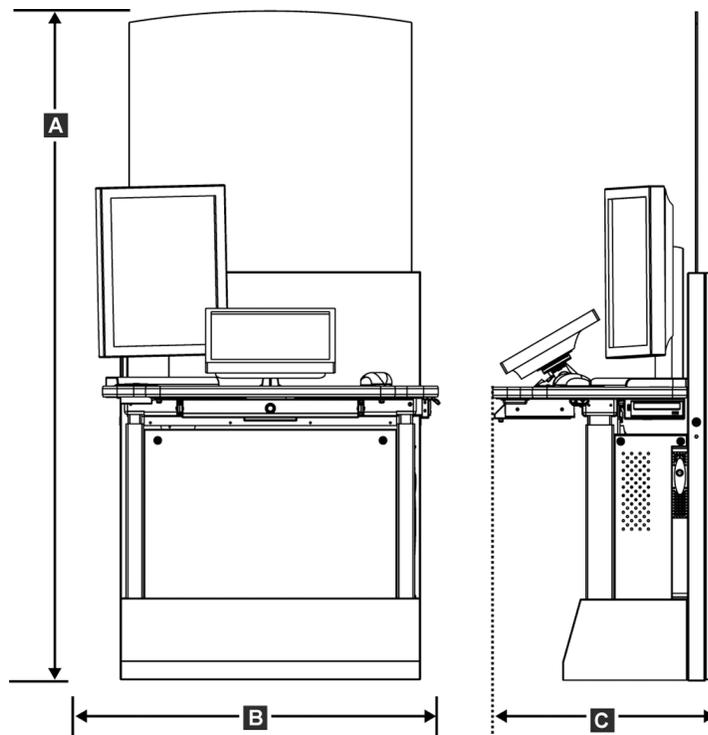
Figura 107: Medidas da Estação de trabalho Acquisition Padrão
