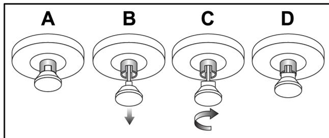
Figura 113: Trava da bandeja liberada de Travada (A) para Destravada (D)
