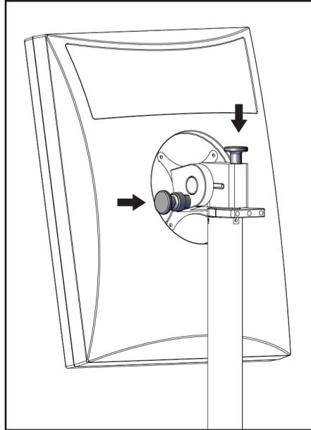
Figura 114: Gire os botões de controle de travamento dos monitores na Estação de Trabalho de Captura Universal Móvel (série I)
