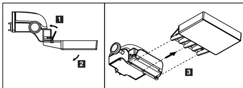
Figura 71: Modalità di rimozione di una piastra di compressione
