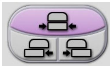
Figura 36: Pulsanti di spostamento della piastra di compressione
