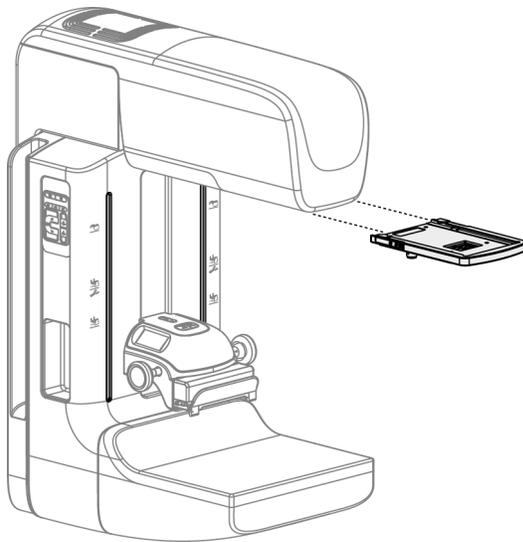
Figura 75: Modalità di installazione e rimozione del mirino di ingrandimento
