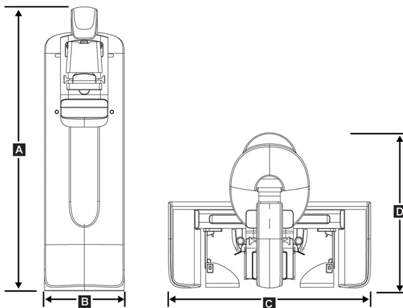
Figura 104: Misure della colonna (gantry con braccio a C)
