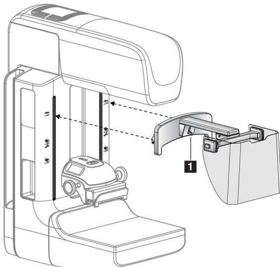
Figura 67: Installazione dello schermo facciale
