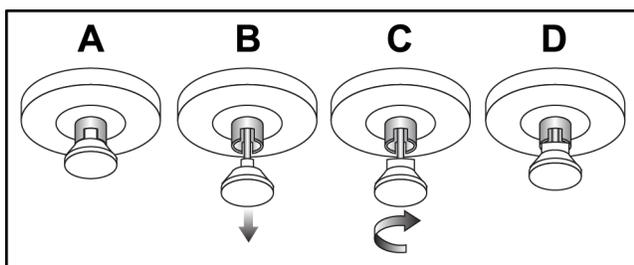
Figura 113: Rilascio del blocco del portatastiera da bloccato (A) a sbloccato (D)
