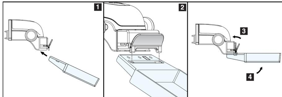
Figura 70: Modalità di installazione di una piastra di compressione
