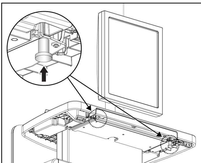
Figura 111: Manopola di blocco del portatastiera, lato destro o sinistro (stazione di acquisizione universale)
