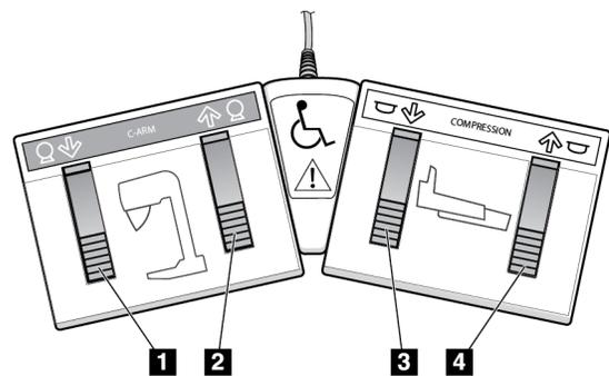
Figura 11: Interruttore a pedale a doppia funzione
