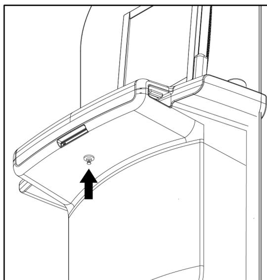
Figura 112: Manopola di blocco del portatastiera (stazione di lavoro Premium)
