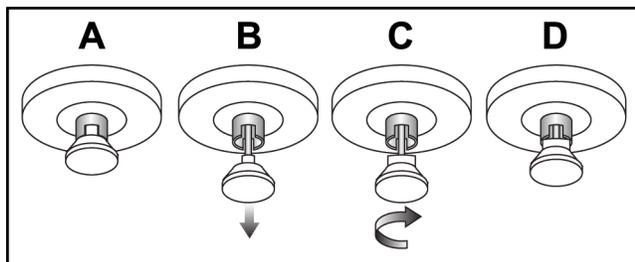
Figura 116: Rilascio del blocco del portatastiera da bloccato (A) a sbloccato (D)
