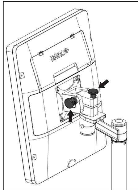
*Figura 115: Manopole di blocco del monitor girevole sulla stazione di acquisizione universale mobile (serie II)*
