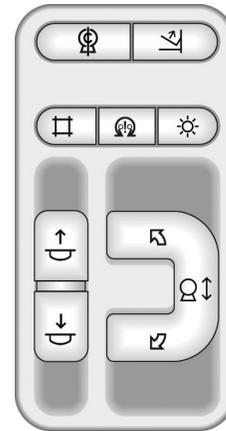
Figura 10: Pannello di controllo del braccio a C
