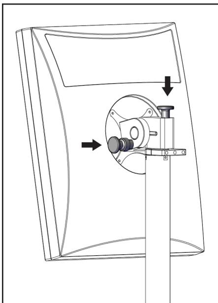
Figura 117: Manopole di blocco del monitor girevole sulla stazione di acquisizione universale mobile (serie I)
