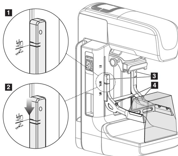
Figura 73: Installazione del piedistallo di ingrandimento
