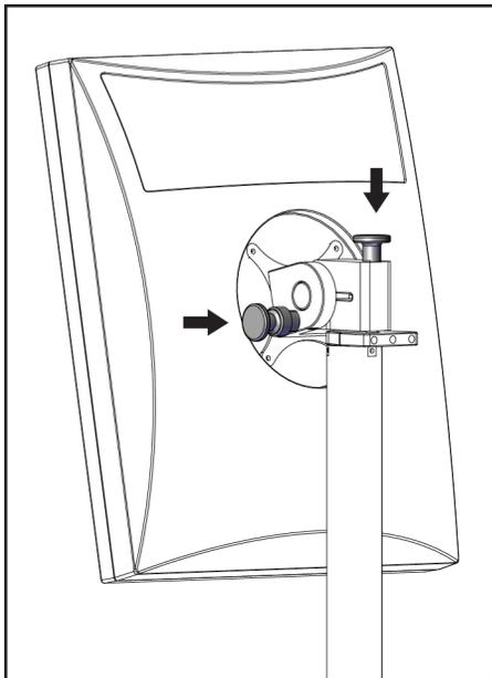
*Figura 114: Manopole di blocco del monitor girevole sulla stazione di acquisizione universale mobile (serie I)*
