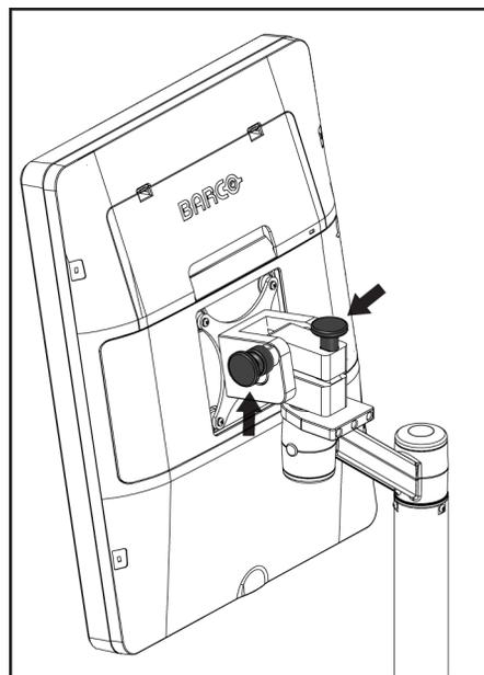
Figura 118: Manopole di blocco del monitor girevole sulla stazione di acquisizione universale mobile (serie II)
