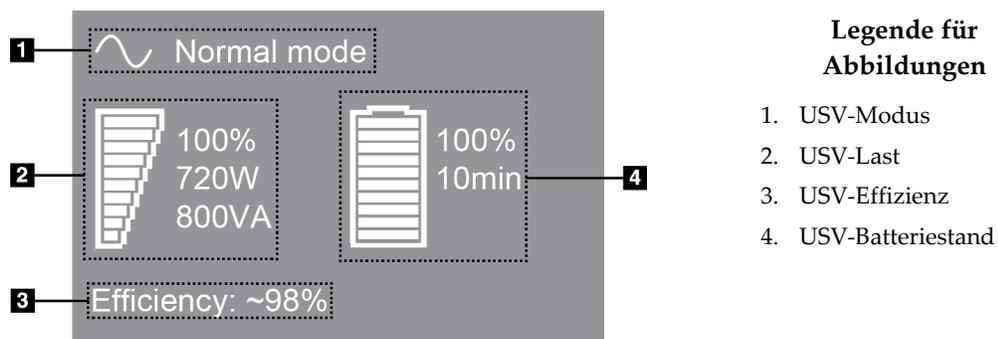
Abbildung 110: USV LCD-Display
