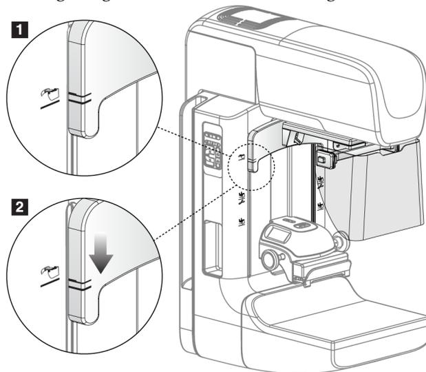
Abbildung 66: Richten Sie den einziehbaren Gesichtsschutz am C-Bogen aus
