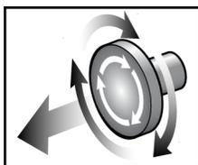
*Abbildung 15: Die Not-Aus-Schalter durch Drehen zurücksetzen*
