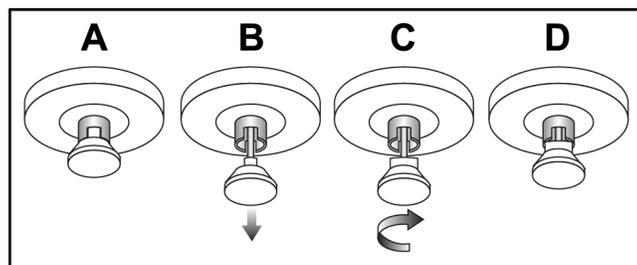
Abbildung 113: Lösen der Verriegelung des Fachs von Verriegelt (A) zu Entriegelt (D)
