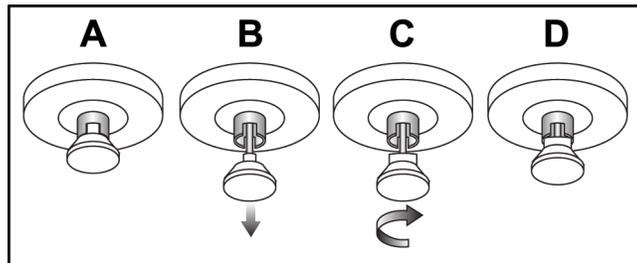
Abbildung 116: Lösen der Verriegelung des Fachs von Verriegelt (A) zu Entriegelt (D)
