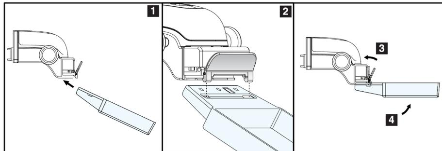
Abbildung 70: So installieren Sie eine Kompressionsplatte
