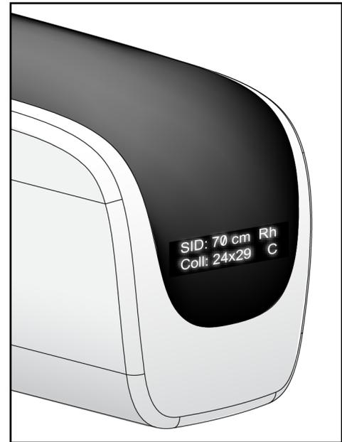
Abbildung 7: Strahlerkopf-Display
