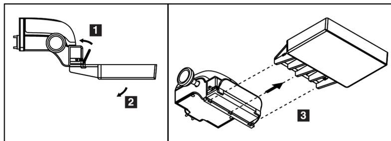
Abbildung 71: So entfernen Sie eine Kompressionsplatte
