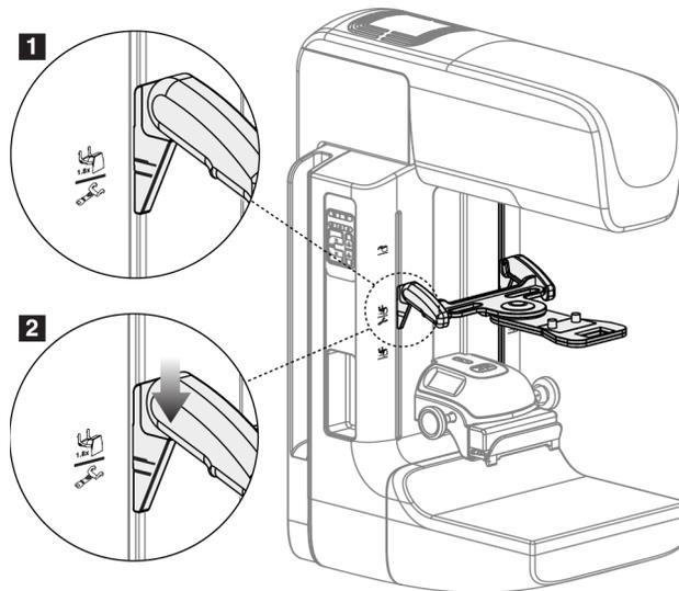
Abbildung 74: Installation der Lokalisierungs-Fadenkreuzvorrichtung
