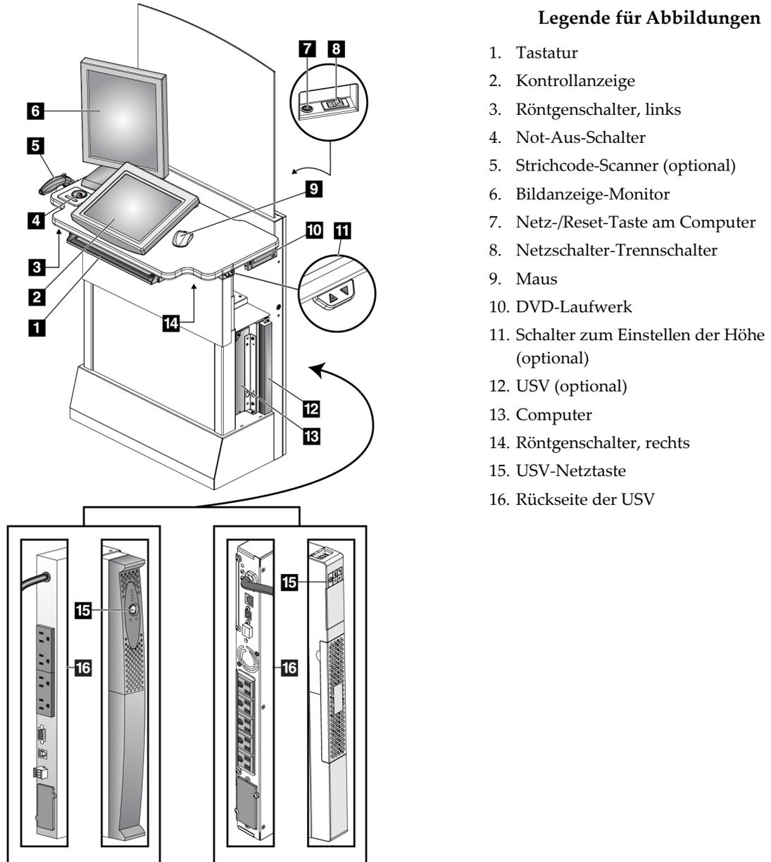
Abbildung 14: Bedienelemente und Anzeigen der Standard-Akquisitions-Workstation
