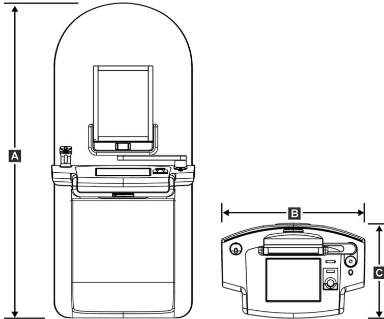
Abbildung 106: Abmessungen Premium-Akquisitions-Workstation
