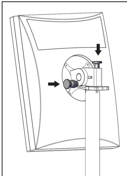
Abbildung 117: Knöpfe zur Verriegelung des drehbaren Monitors an der mobilen Universal-Akquisitions-Workstation (Serie I)
