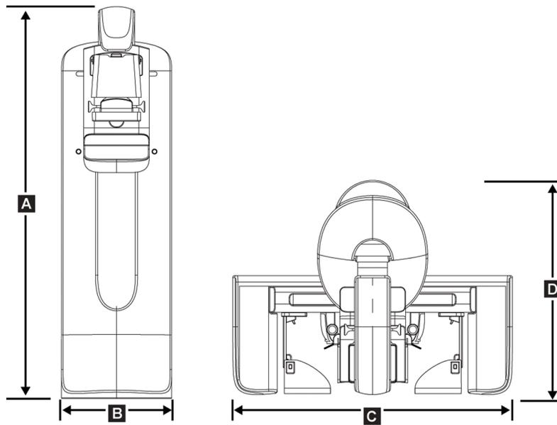
Abbildung 104: Abmessungen Säulenstativ (Gantry mit C-Bogen)
