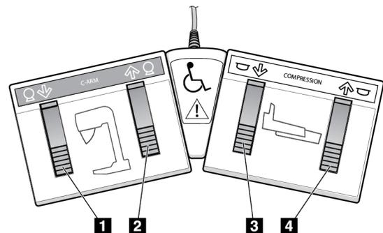
Abbildung 11: Zweifunktions-Fußschalter
