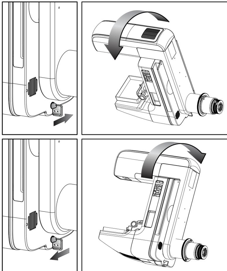
**Automatische C-Bogen-Drehung (Auto-Rotate)**
