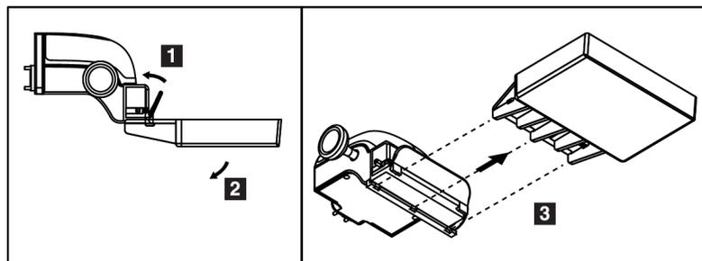
Figure 71 : Pour retirer une pelote de compression
