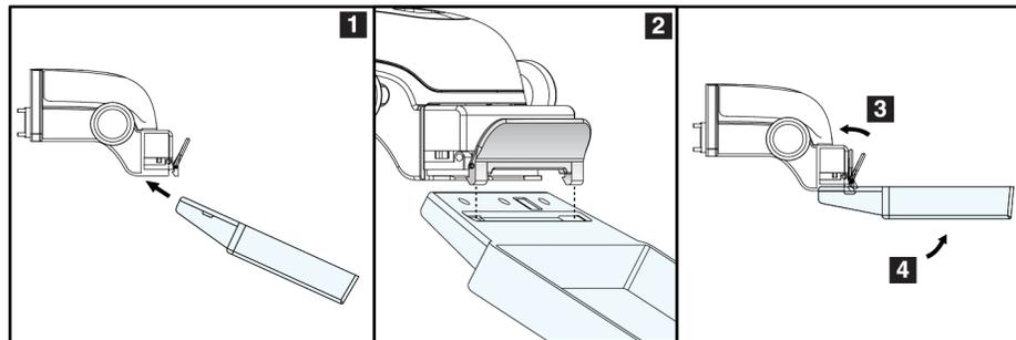
Figure 70 : Pour installer une pelote de compression
