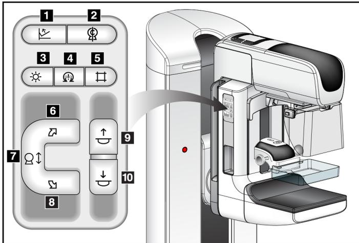
Figure 22 : Panneau de commande du bras en C
