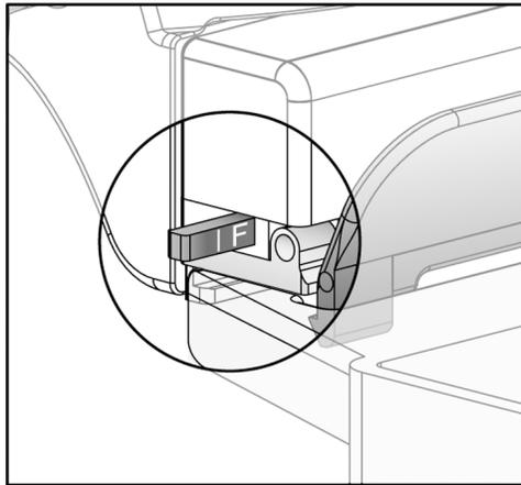
*Figure 72 : Bouton coulissant du mode de compression FAST*
