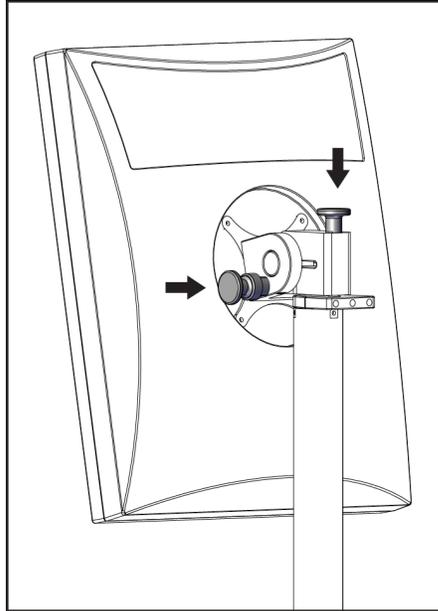
*Figure 114 : Boutons de verrouillage de l'écran pivotant sur la station d'acquisition universelle mobile (série I)*
