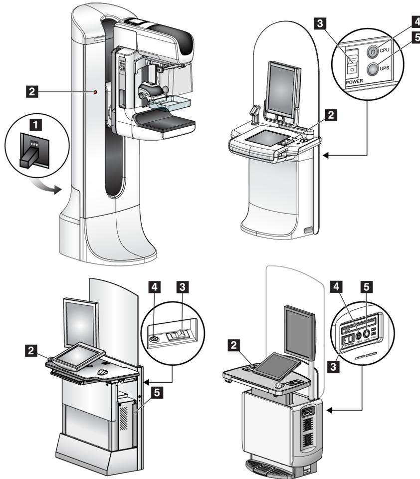
Figure 5 : Commandes d'alimentation électrique du système
