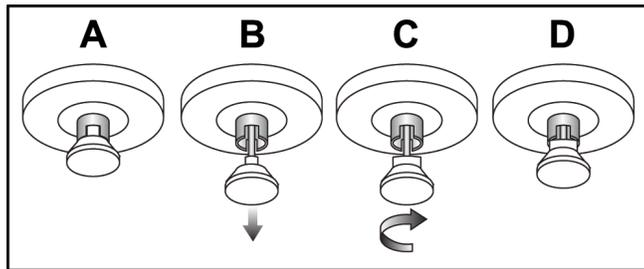
*Figure 116 : Dégagement du plateau de la position verrouillée (A) en position déverrouillée (D)*
