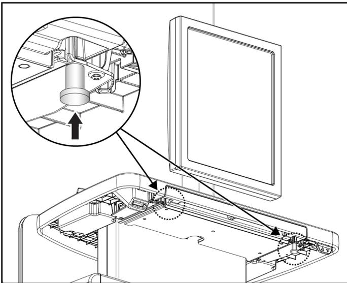
Figure 111 : Molette de verrouillage du plateau du clavier, côté droit ou gauche (station d'acquisition universelle)
