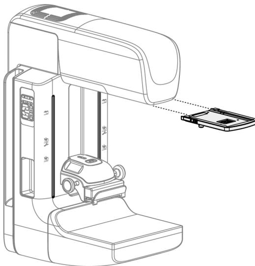
Figure 75 : Pour installer et retirer le dispositif réticulaire d'agrandissement
