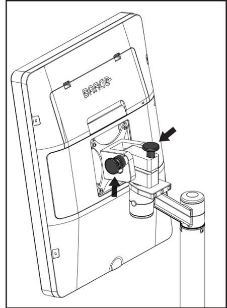
*Figure 115 : Boutons de verrouillage de l'écran pivotant sur la station d'acquisition universelle mobile (série II)*
