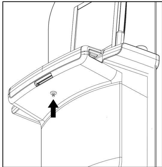
Figure 112 : Molette de verrouillage du plateau du clavier (station d'acquisition haut de gamme)
