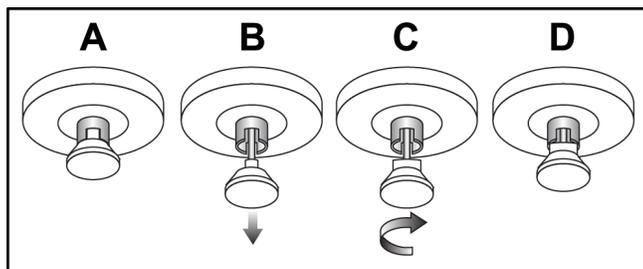
Figure 113 : Dégagement du plateau de la position verrouillée (A) en position déverrouillée (D)
