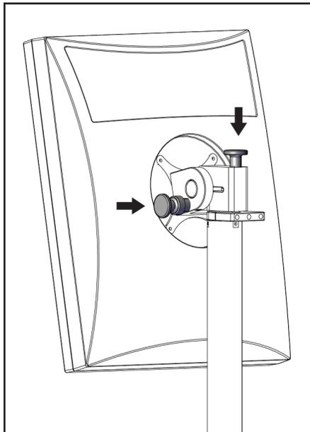
*Figure 117 : Boutons de verrouillage de l'écran pivotant sur la station d'acquisition universelle mobile (série I)*
