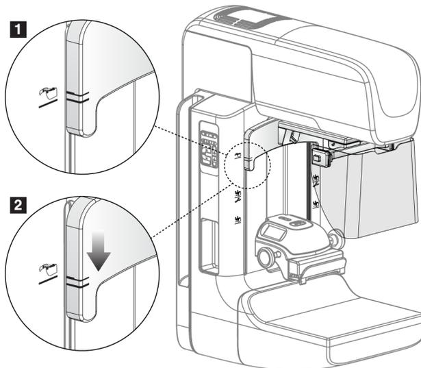
Figure 66 : Aligner l'écran facial rétractable sur le bras en C
