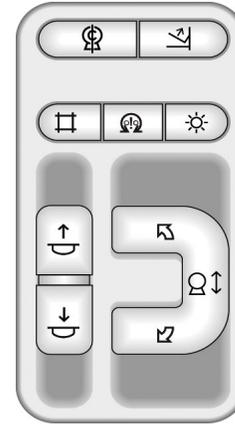
Figure 10 : Panneau de commande du bras en C
