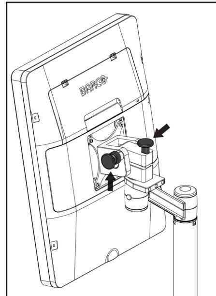
*Figure 118 : Boutons de verrouillage de l'écran pivotant sur la station d'acquisition universelle mobile (série II)*
