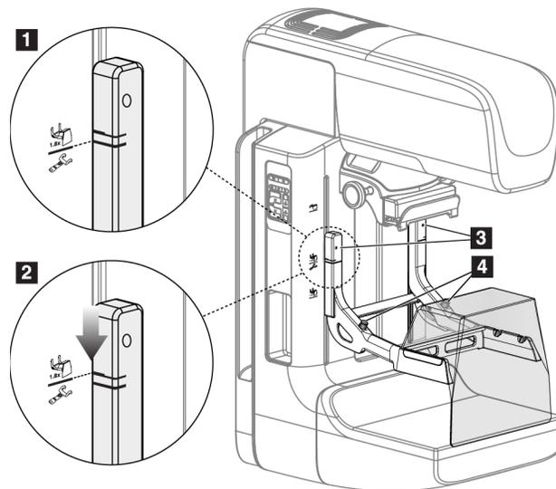
Figure 73 : Installation de la plaque d'agrandissement
