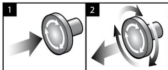
Figure 23 : Fonctionnalité du bouton d'arrêt d'urgence
