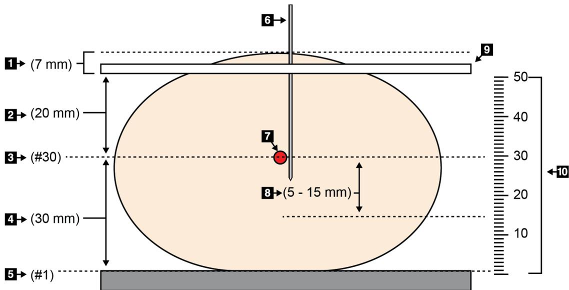
Figure 79 : Calcul de la profondeur de l'aiguille
