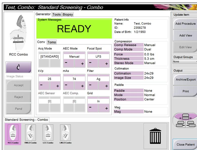
図30: Procedure (プロシージャ) 画面例の[Generator] (発生装置) タブ
