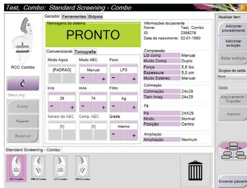
Figura 26: A guia Generator (Gerador) em uma tela de exemplo de procedimento
