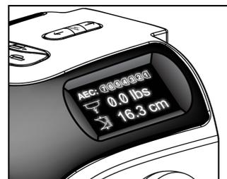
Figura 10: Display di compressione
