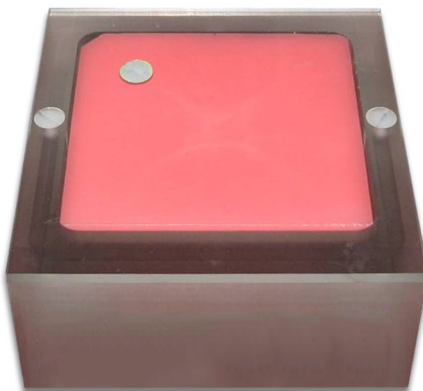
図7. ファントムの上にアクリル製ディスクを置く
