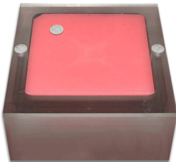
図15. ファントムの上にアクリル製ディスクを置く
