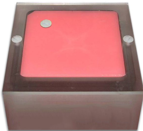
図6. ファントムの上にアクリル製ディスクを置く
