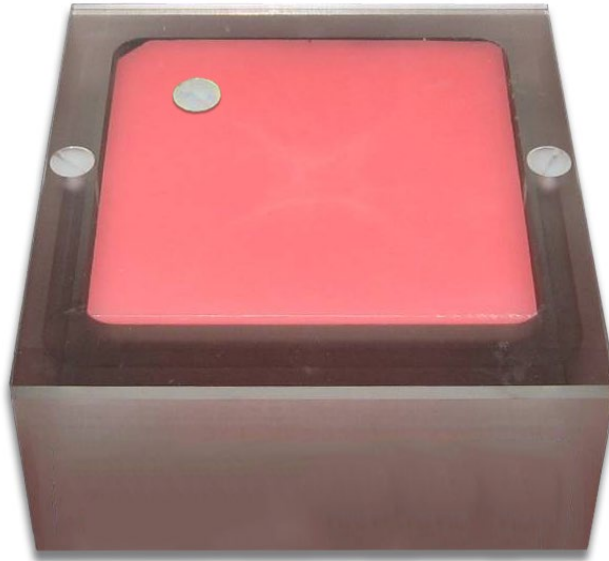
図14. ファントムの上にアクリル製ディスクを置く
