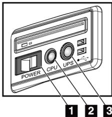
Figura 23: Botones de alimentación de la estación de trabajo de adquisición universal
