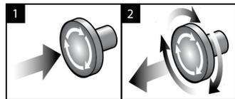
Figura 4: Funcionalidad de interruptor de apagado de emergencia
