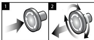
Figura 22: Funcionalidad de interruptor de apagado de emergencia
