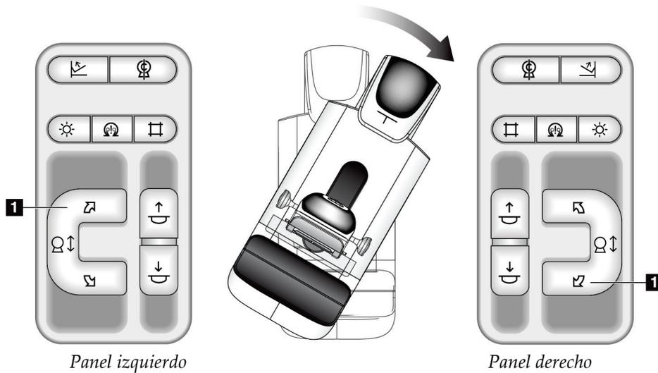
*Tabla 5: Interruptor de rotación del brazo del colimador*
