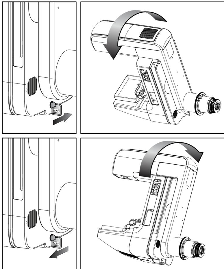
**Rotación automática del brazo del colimador (rotación automática)**
