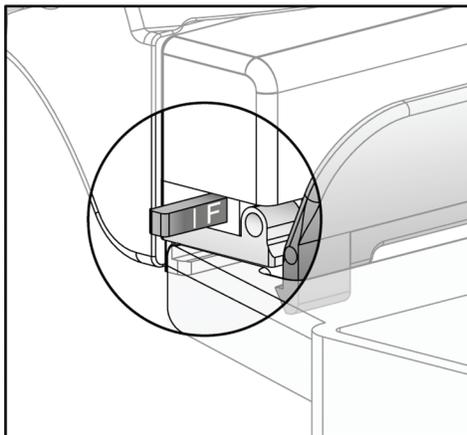
Figura 66: Control deslizante del modo de compresión FAST
