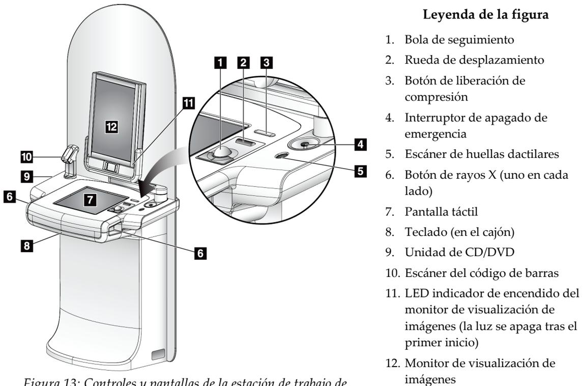
Figura 13: Controles y pantallas de la estación de trabajo de adquisición Premium
