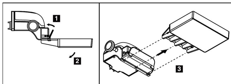
Figura 65: Cómo extraer una pala de compresión
