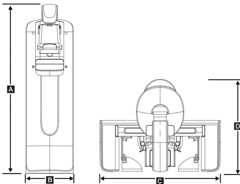
Figura 98: Medidas del soporte tubular (gantry con brazo del colimador)
