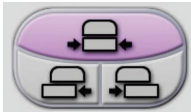
Figura 35: Botones de desplazamiento de la pala
