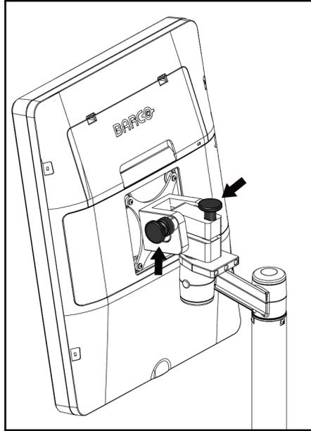
*Figura 110: Perillas para bloqueo del monitor de visualización de imágenes en la estación de trabajo de adquisición universal móvil*
