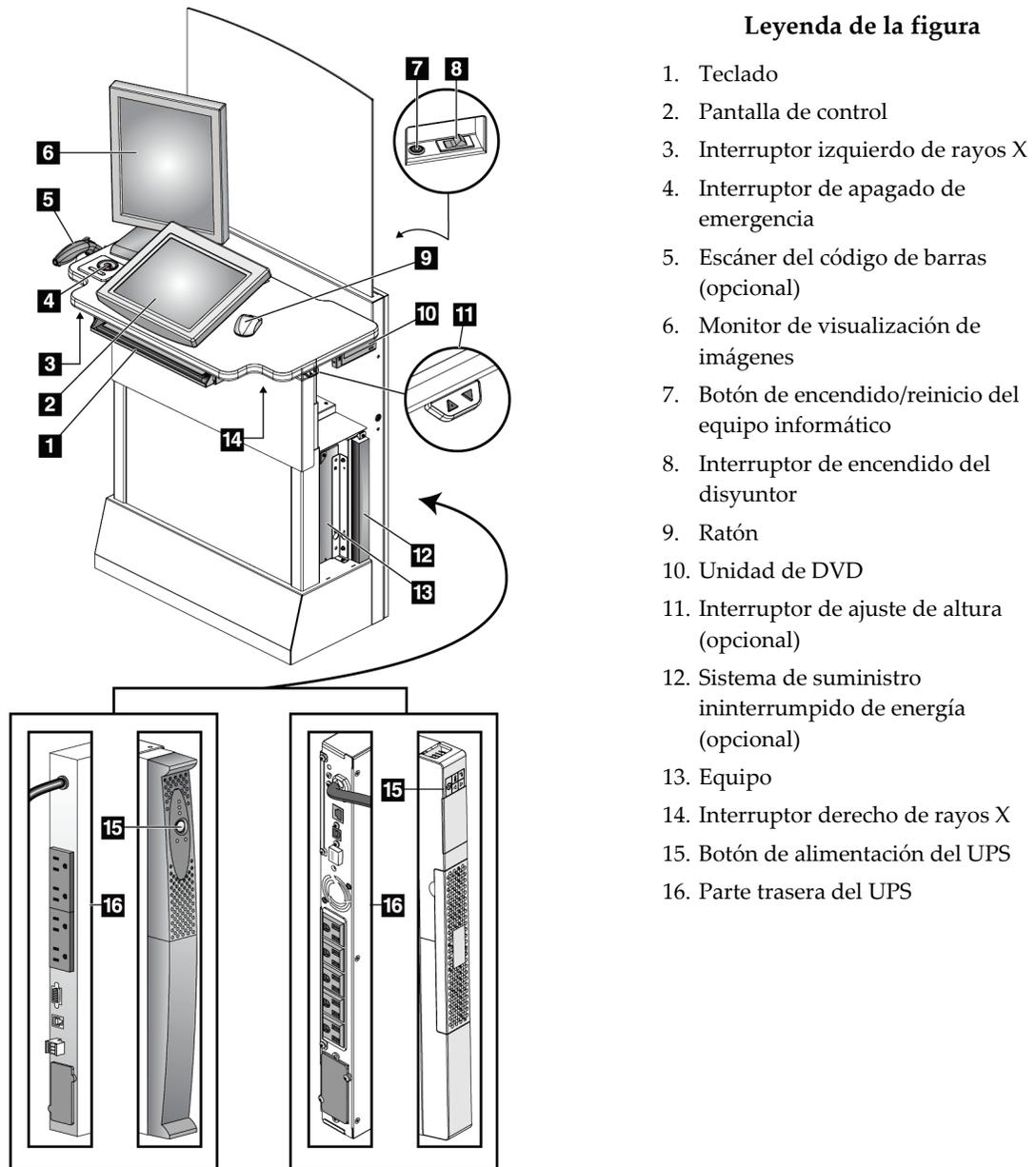
Figura 14: Controles y pantallas de la estación de trabajo de adquisición estándar
