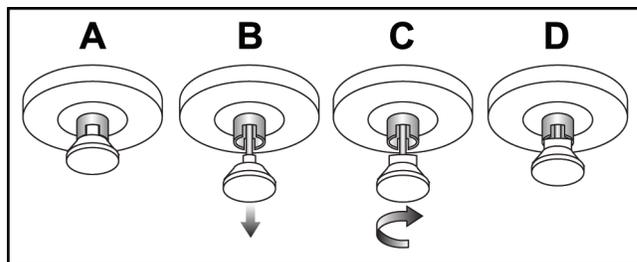
Figura 109: Liberación de la bandeja, de la posición bloqueada (A) a la desbloqueada (D).
