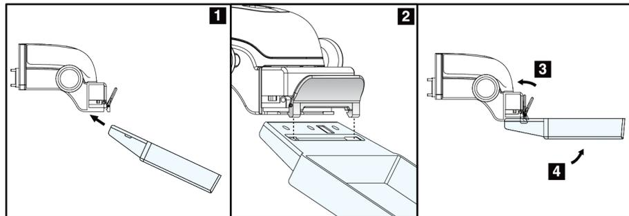
Figura 64: Instalación de la pala de compresión
