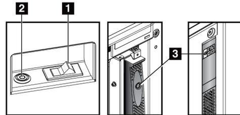
Figura 25: Botones de encendido de la estación de trabajo de adquisición estándar
