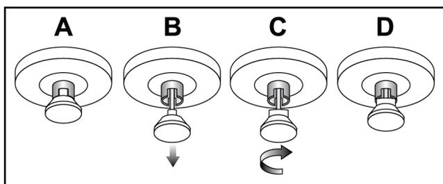
Figura 107: Liberación de la bandeja, de la posición bloqueada (A) a la desbloqueada (D).
