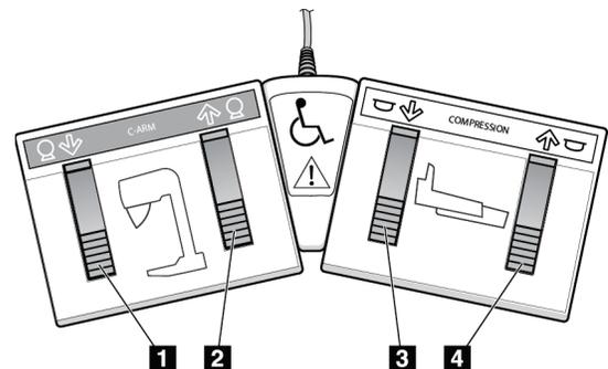
Figura 11: Interruptor de pedal de doble función
