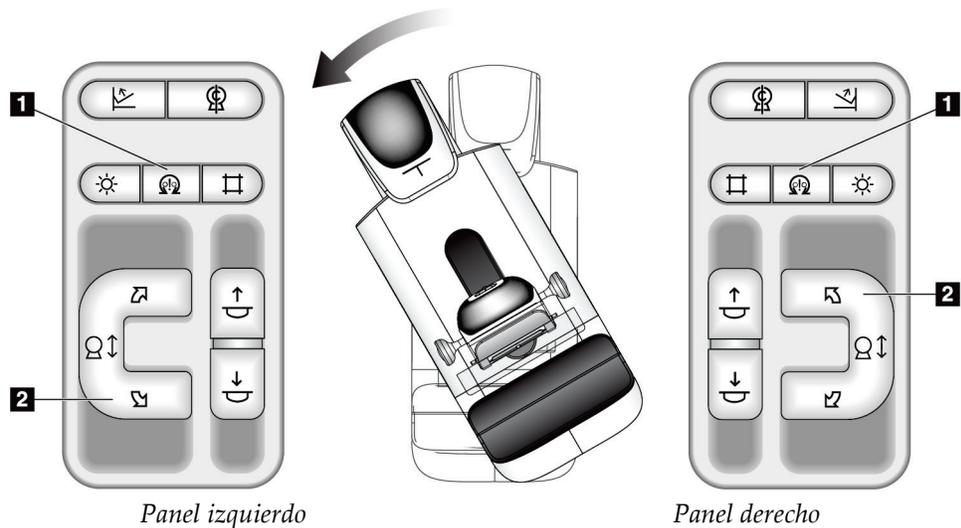
*Tabla 7: Rotación automática del brazo del colimador hacia la derecha*
