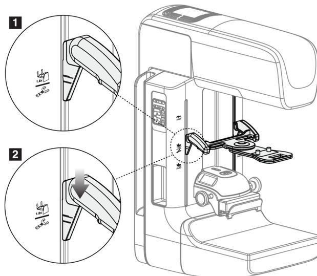
Figura 68: Instalación del retículo de localización
