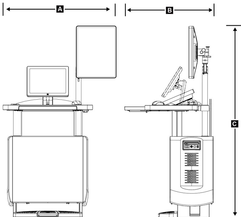
Figura 102: Medidas de la estación de trabajo de adquisición universal móvil
