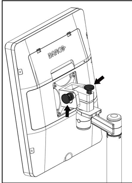
Figura 108: Perillas para bloqueo del monitor de visualización de imágenes en la estación de trabajo de adquisición universal móvil
