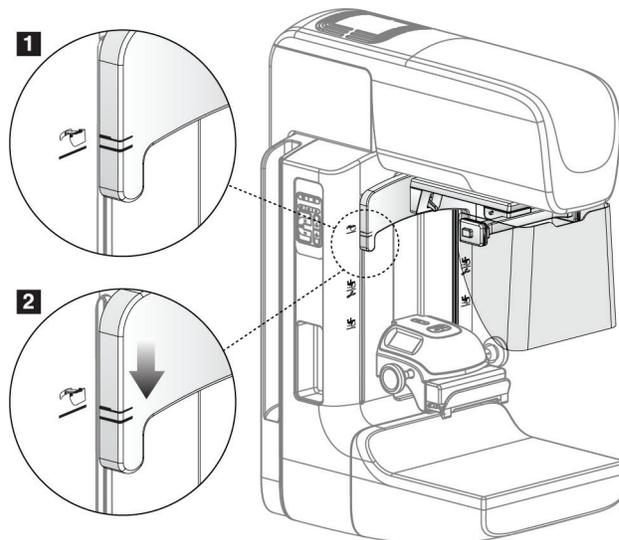
Figura 60: Alinee la máscara retráctil en el brazo del colimador
