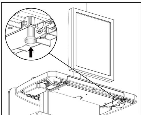
Figura 105: Perilla de bloqueo de la bandeja del teclado
