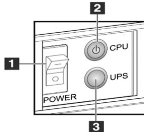
Figura 24: Botones de encendido de la estación de trabajo de adquisición Premium
