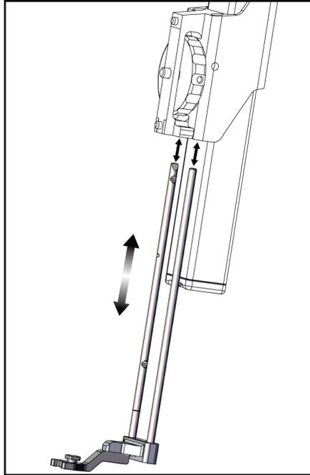
*Figura 17: Remoção do fixador do guia da agulha do suporte do dispositivo padrão*
