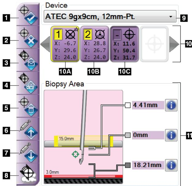
図54: [Biopsy] (生検) タブの画面に表示された機能ボタンとデータ (標準ニードルアプローチの場合)
