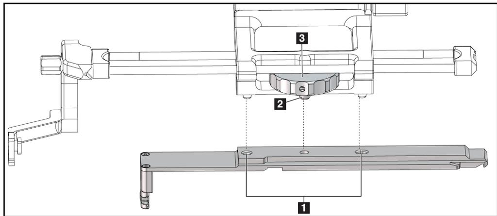
図26: デバイスマウント（側方アーム）に生検デバイスアダプターを取り付ける
