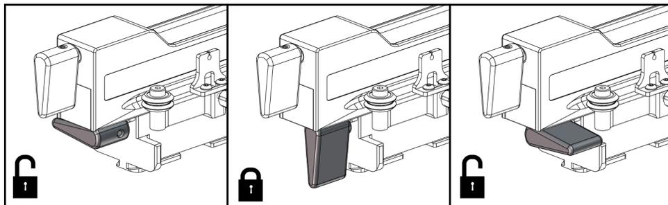
図24: ロック状態/ロック解除状態におけるデバイスマウントのレバーの位置
