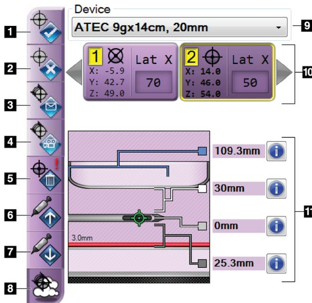
図55: [Biopsy] (生検) タブの画面に表示された機能ボタンとデータ (側方ニードルアプローチの場合)
