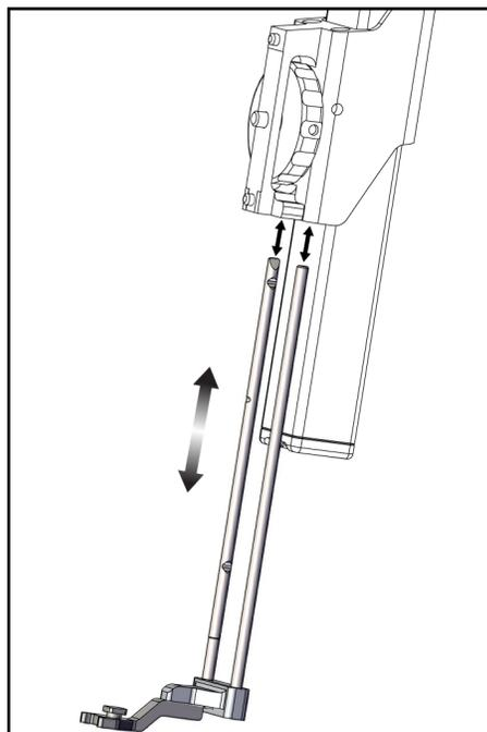
図10: 標準のデバイスマウントにニードルガイドを取り付ける
