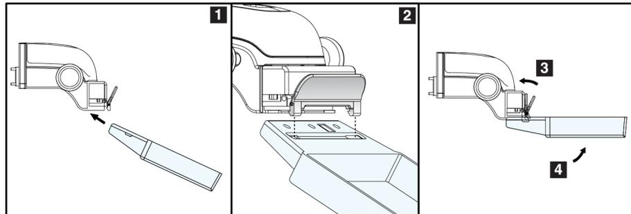
Figura 76: Instalación de una pala de compresión
