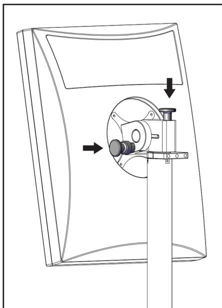
Figura 129: Perillas de bloqueo del monitor basculante en la estación de trabajo de adquisición universal móvil (serie I)
