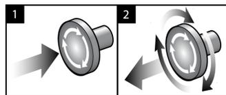
Figura 27: Funcionalidad de interruptor de apagado de emergencia
