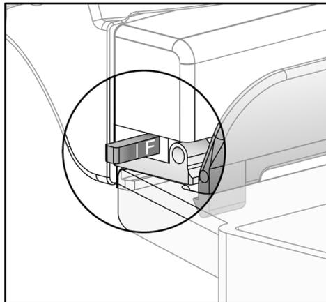
Figura 78: Control deslizante del modo de compresión FAST
