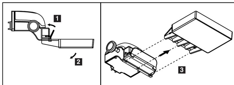
Figura 77: Cómo extraer una pala de compresión
