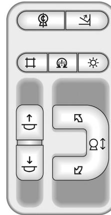
Figura 14: Panel de control del brazo del colimador
