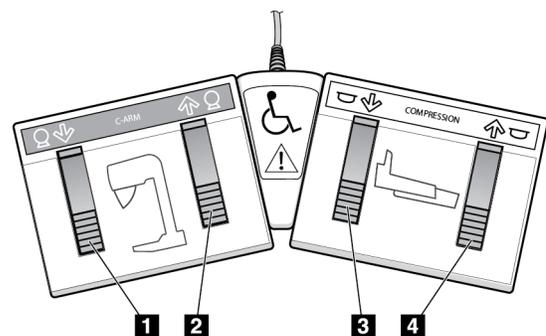
Figura 15: Interruptor de pedal de doble función
