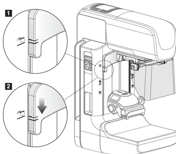
Figura 72: Alinee la máscara retráctil en el brazo del colimador
