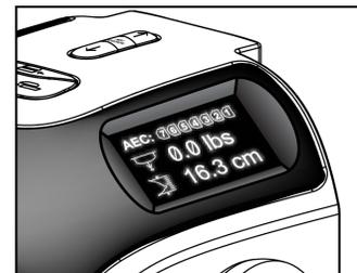
Figura 13: Pantalla del dispositivo de compresión
