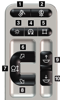
Figura 11: Panel de control del brazo del colimador
