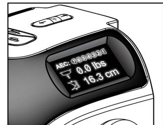
Figura 8: Visor do dispositivo de compressão
