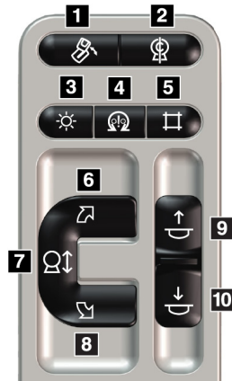
Figura 9: Panel de control del brazo del colimador
