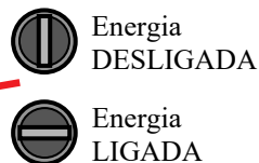
Figura 5.1.2 Interruptor de chave
