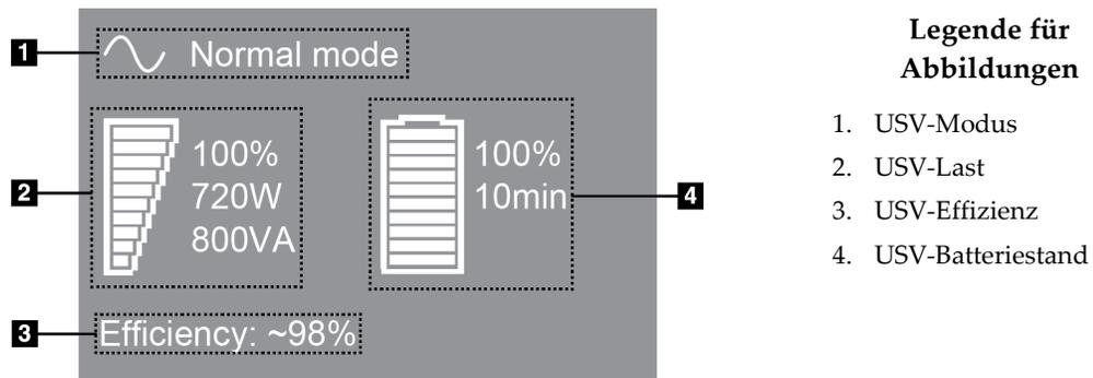
Abbildung 115: USV LCD-Display
