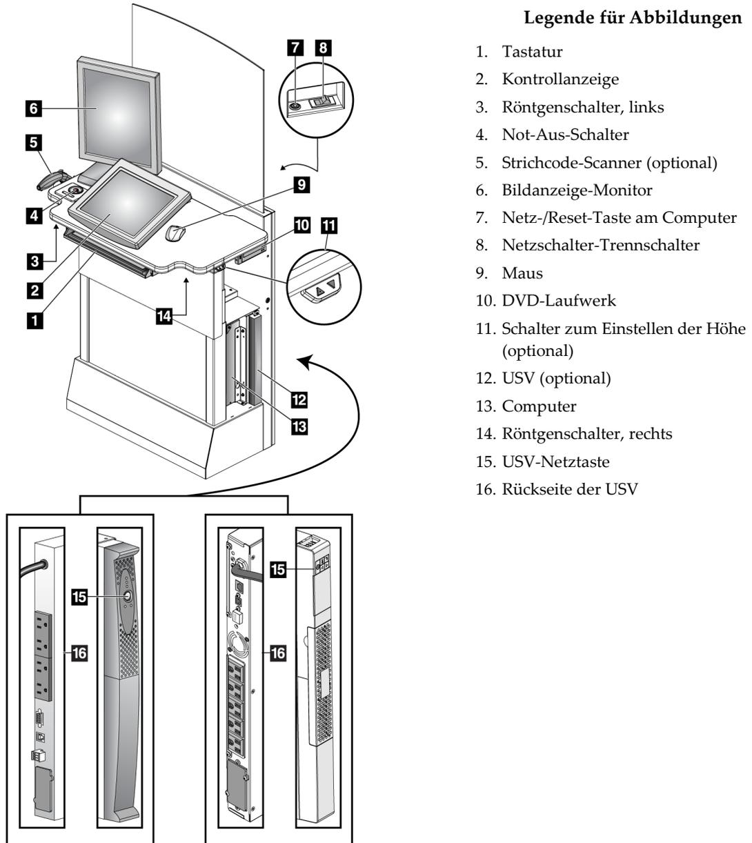
Abbildung 14: Bedienelemente und Anzeigen der Standard-Akquisitions-Workstation
