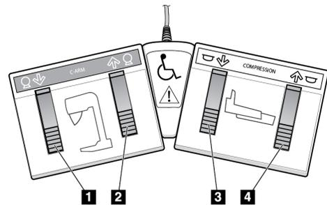
Abbildung 11: Zweifunktions-Fußschalter
