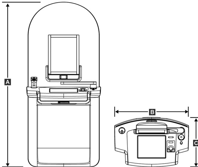
Abbildung 111: Abmessungen Premium-Akquisitions-Workstation
