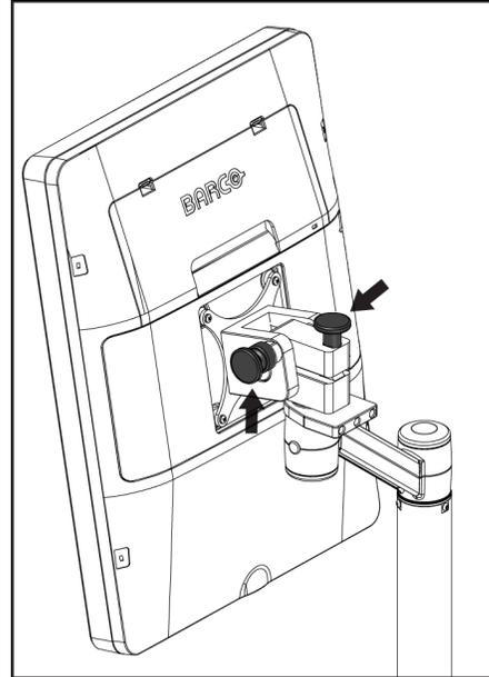
Abbildung 120: Knöpfe zur Verriegelung des drehbaren Monitors an der mobilen Universal-Akquisitions-Workstation (Serie II)
