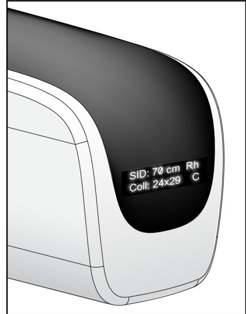
Abbildung 7: Strahlerkopf-Display
