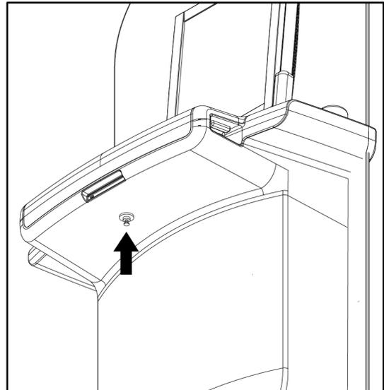
Abbildung 117: Tastaturfach-Verriegelungsknopf (Premium-Workstation)
