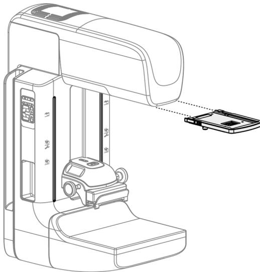
Abbildung 77: So installieren und entfernen Sie die Vergrößerungs-Fadenkreuzvorrichtung
