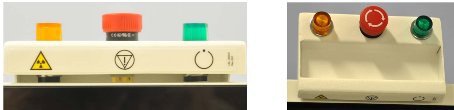
Figure 3 Bouton d'arrêt d'urgence et voyants lumineux
