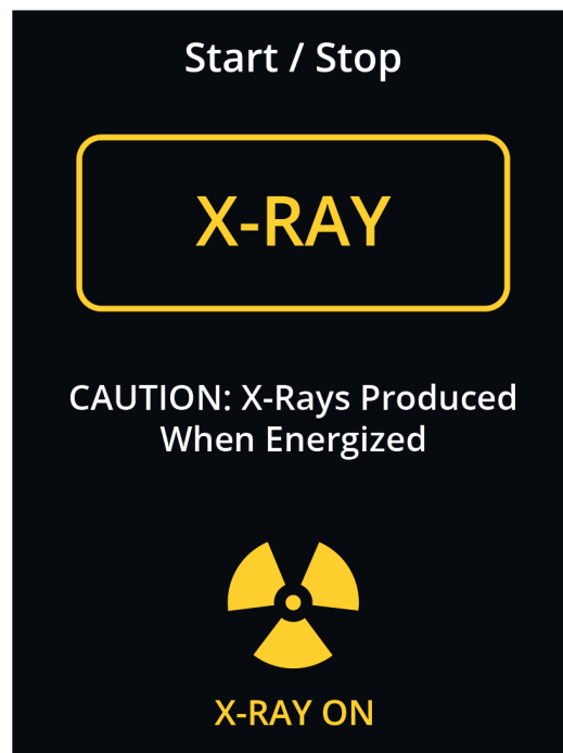
Figura 27: Pulsante X-Ray (Raggi X) mentre l'esposizione è in corso
