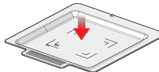
7 Posicione a bandeja de amostras na cabine de imagem para o nível de ampliação necessário.
