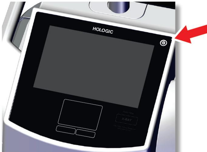
Abbildung 8: Netzschalter des Computers
