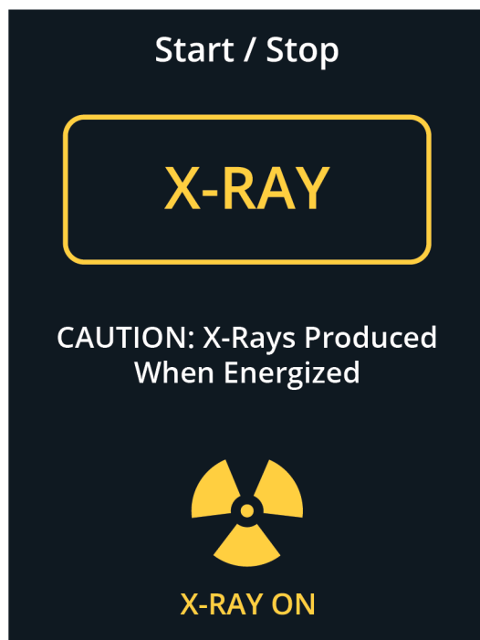
Figur 27: Røntgenknappen, mens eksponeringen er i gang
