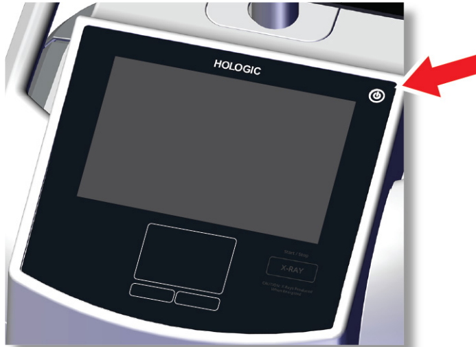
Figura 8: Interruptor de alimentación del equipo
