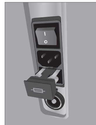
Ubicación del fusible
