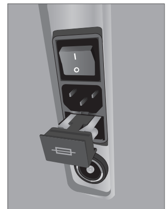
Posizione dei fusibili
