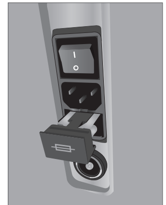
Plassering av sikring
