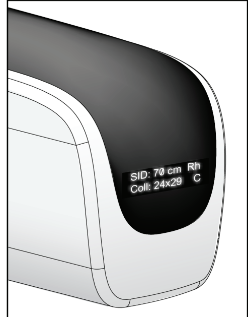
Obrázok 7: Displej na hlavici trubice
