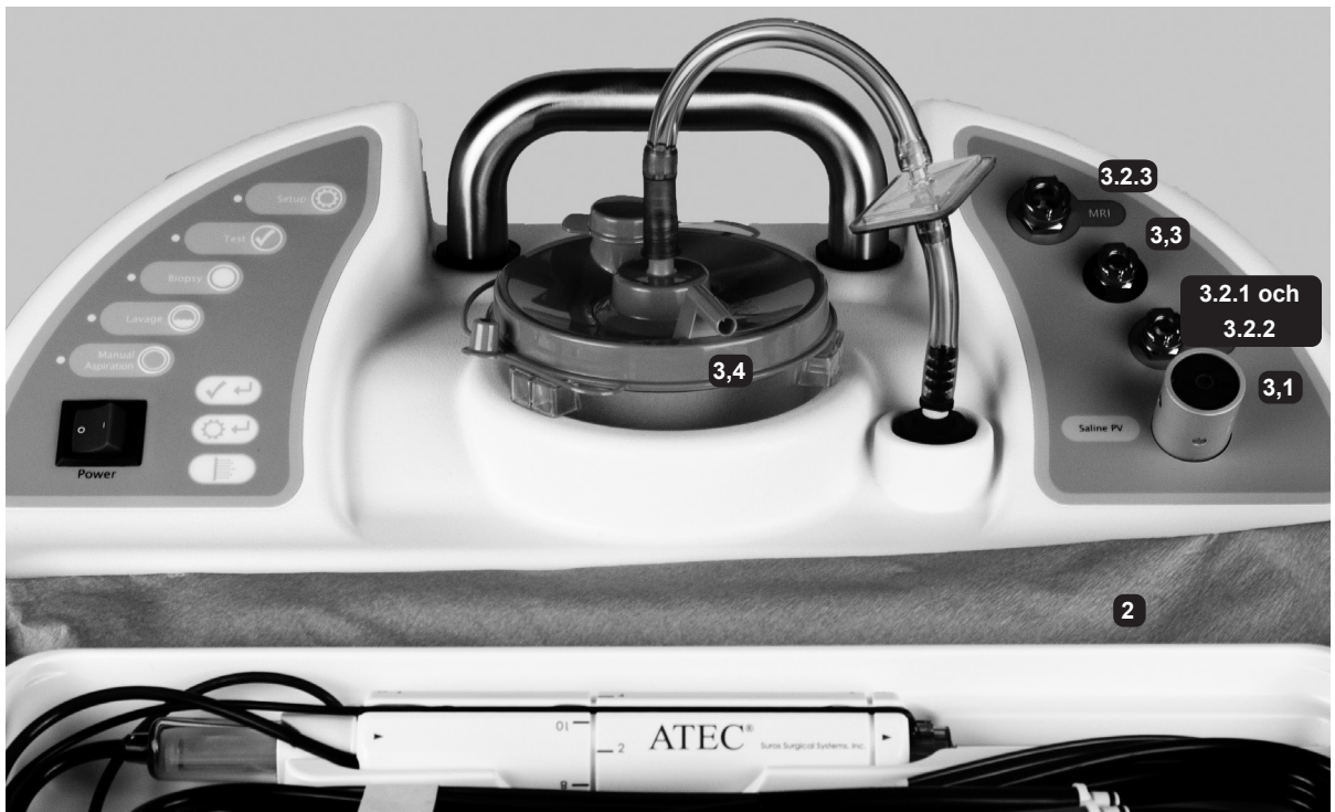
FIGUR 4: VAKUUM- OCH HANDSTYCKESENHET OCH ANSLUTNINGAR
