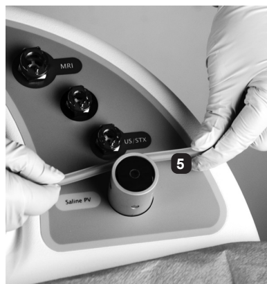
OBRÁZEK 6: PŘIPOJENÍ ŠKRTICÍHO VENTILU FYZIOLOGICKÉHO ROZTOKU
