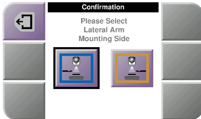
Figuur 19: Keuzescherf voor de montagekant van de laterale arm
