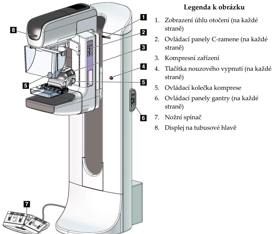
Obrázek 7: Ovládání a indikátory tubusového stojanu
