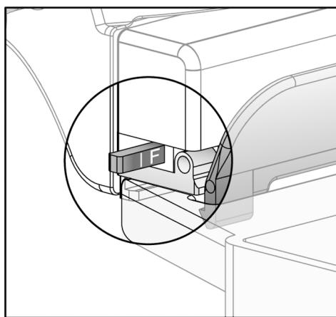
Obrázek 70: Posuvník kompresního režimu FAST.
