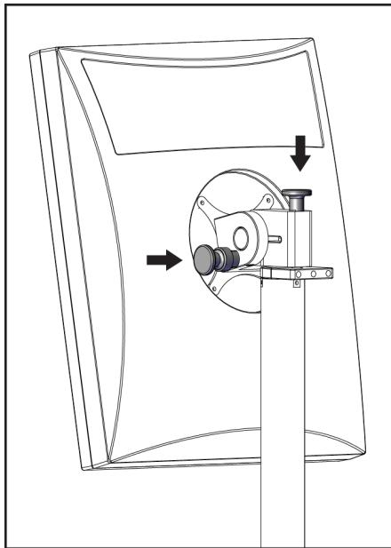
Obrázek 114: Pojistné knoflíky otočného monitoru na mobilní akviziční stanici Universal (řada I)
