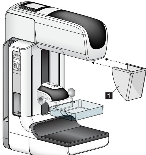
Obrázek 67: Jak nainstalovat konvenční obličejobvý štít
