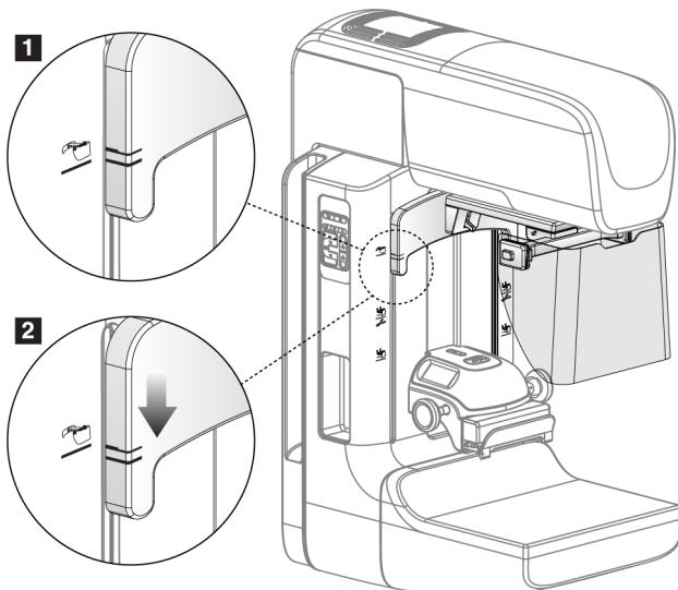
Obrázek 64: Seřízení polohy sklopného obličejového štítu na C-rameni
