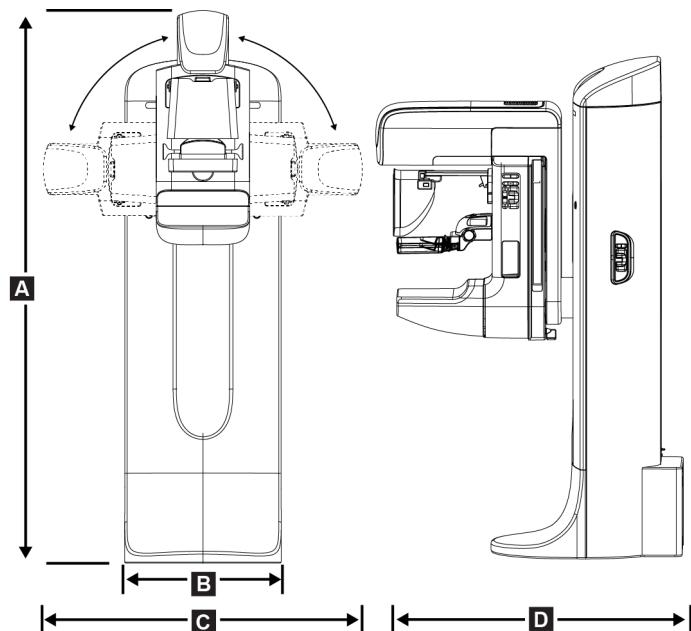
Obrázek 108: Tubusový stojan (gantry a C-rameno) – rozměry
