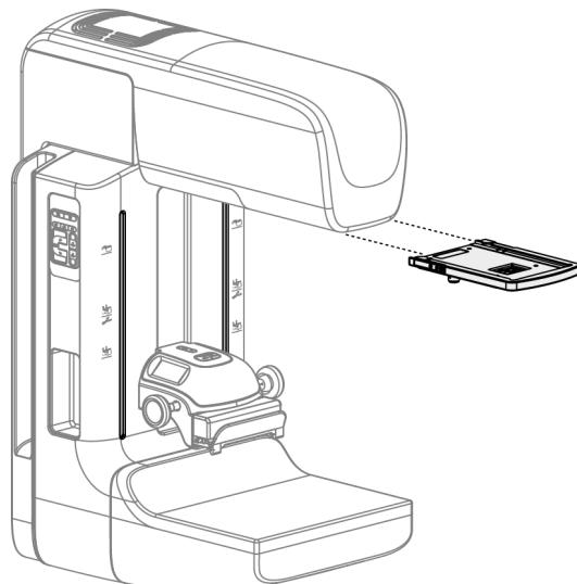
Obrázek 73: Jak nainstalovat a odebrat zvětšovací zařízení se zaměřovačem
