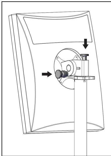
Obrázek 117: Pojistné knoflíky otočného monitoru na mobilní akviziční stanici Universal (řada I)
