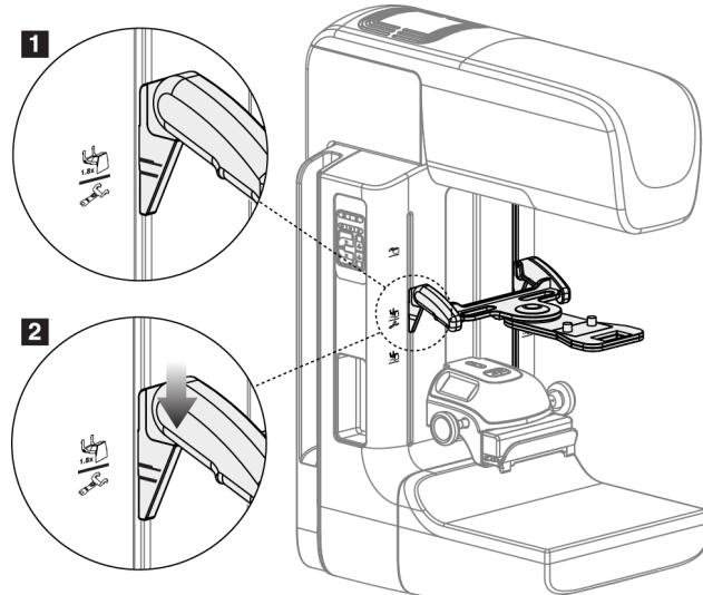
Obrázek 72: Instalace lokalizačního zařízení se zaměřovačem
