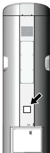
Obrázek 4: Umístění štítku systému gantry
