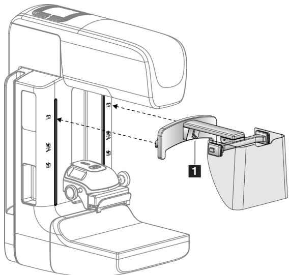
Obrázek 65: Instalace obličejobového štítu
