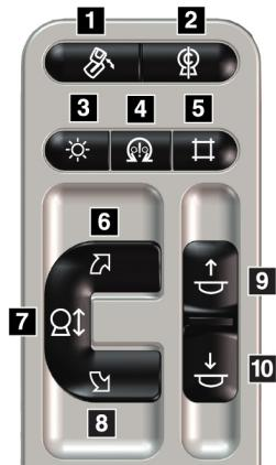
Obrázek 11: Ovládací panel C-ramene
