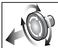
Obrázek 15: Otočením uveděte tlačítka nouzového vypnutí do původní polohy
