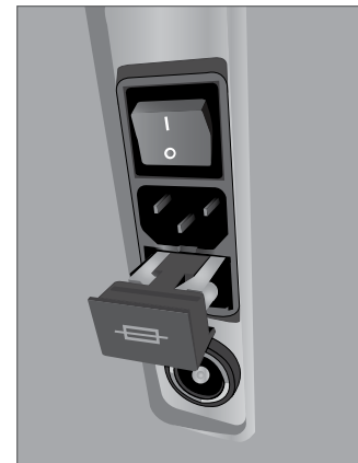
Position der Sicherung
