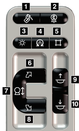
Ábra 10: A C-ív vezérlőpanele
