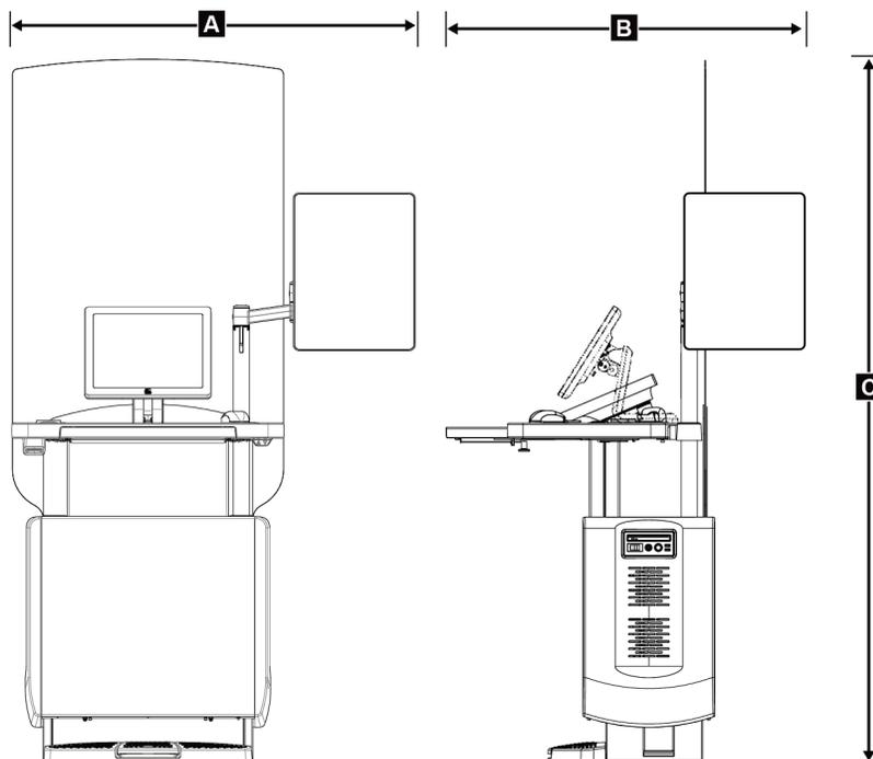
Figură 100: Dimensiunile stației de colectare universale
