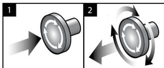
Figură 20: Funcționarea întrerupătorului de oprire de urgență
