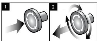
Figură 3: Funcționarea întrerupătorului de oprire de urgență
