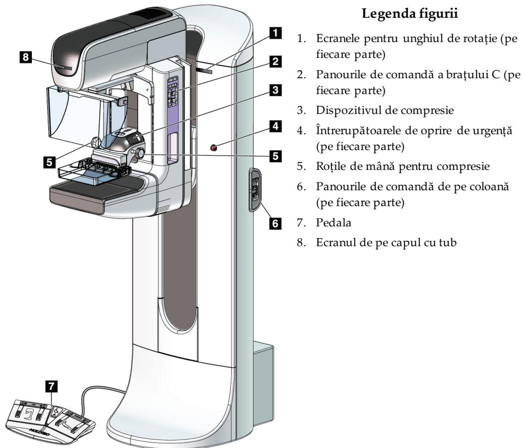
Figură 6: Comenzile și indicatoarele instalației cu tub
