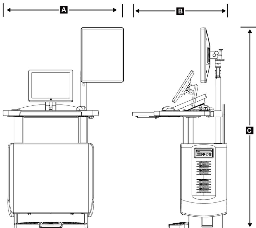
Figură 101: Dimensiunile stației de colectare universale mobile
