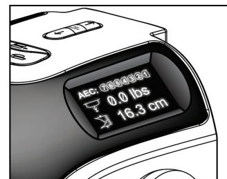
Figuur 10: Display van compressieapparaat
