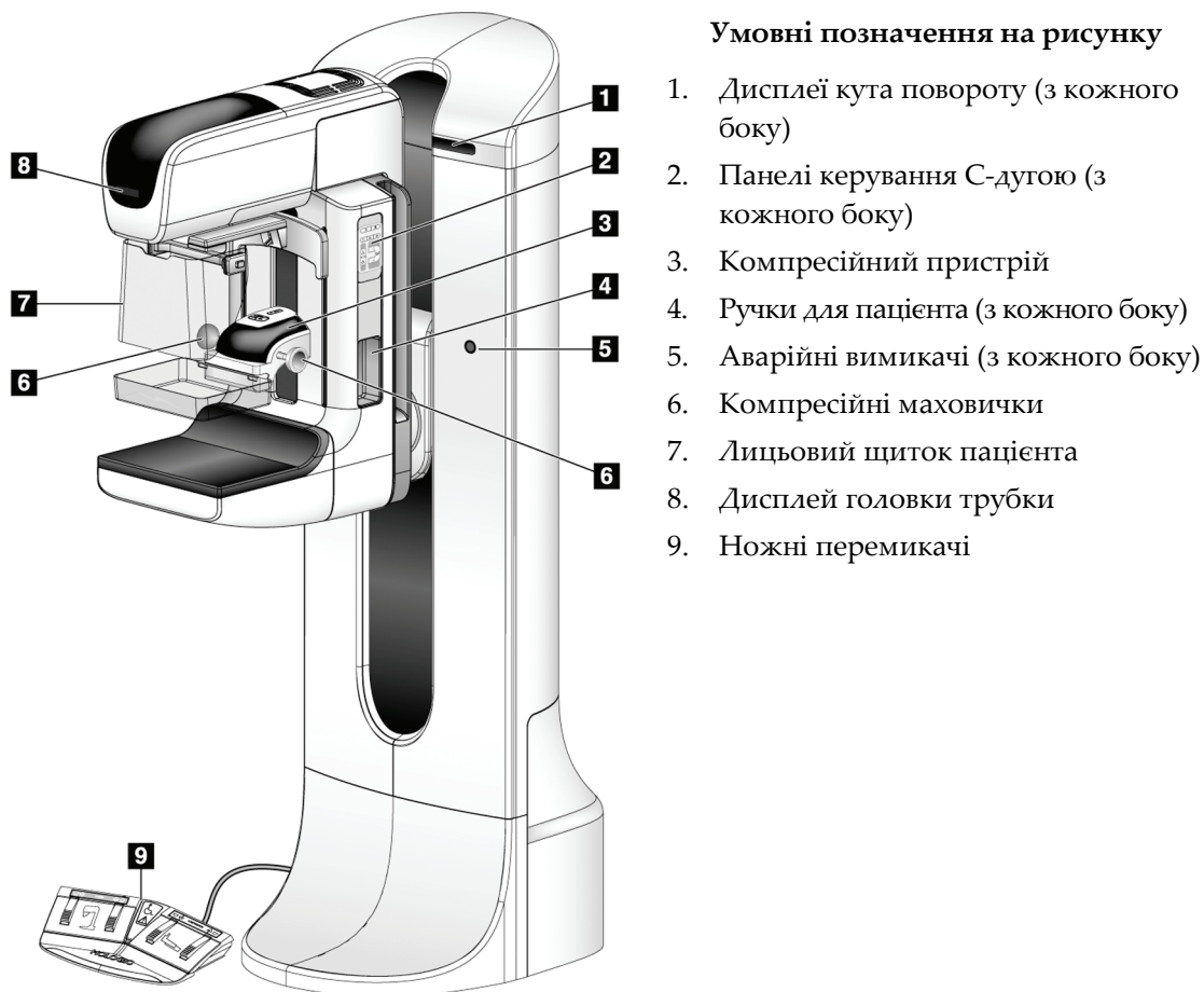
Рисунок 7: Елементи керування та індикатори штатива трубки
