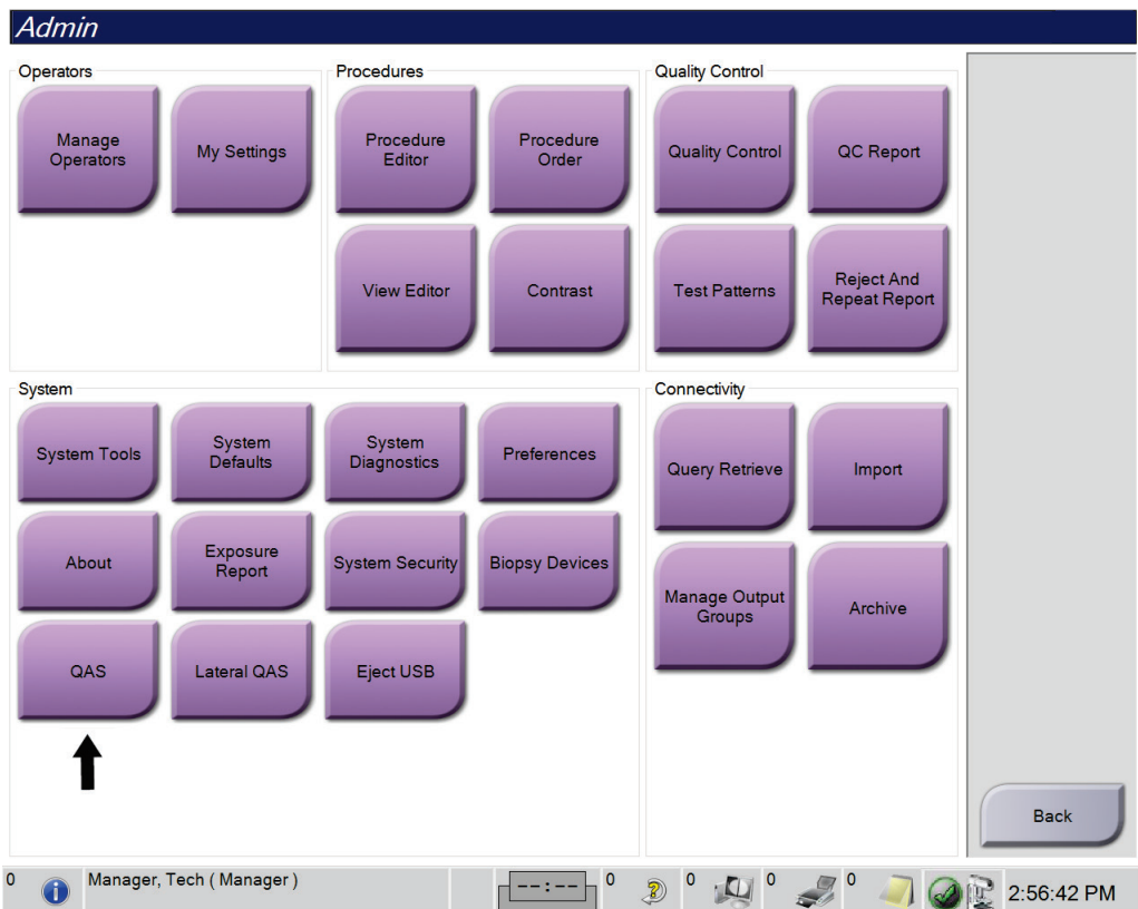
Figura 68: Botón QAS (Sistema de garantía de la calidad) en la pantalla Admin
