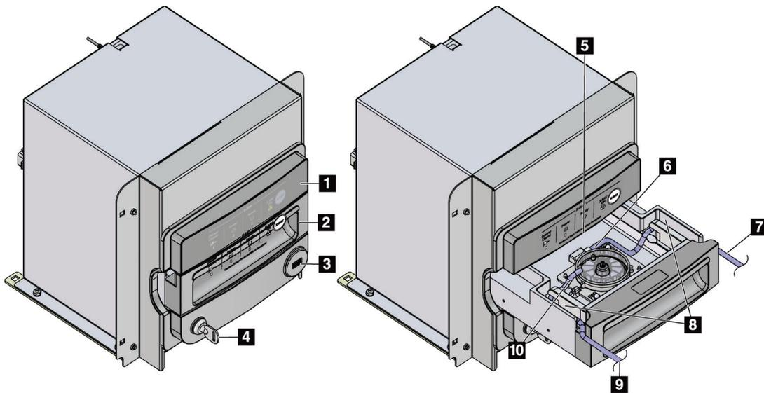
Figura 5: Componentes de la cabina de imágenes
