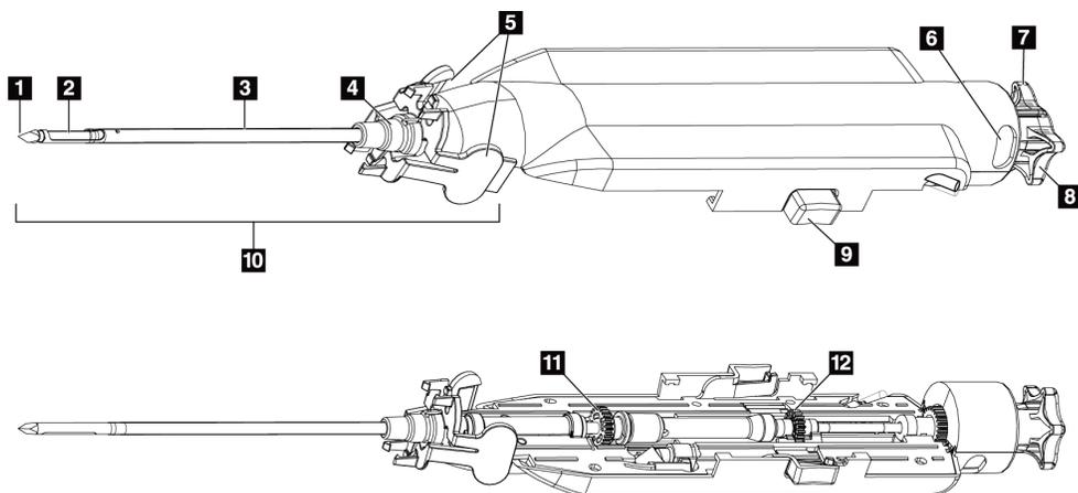
Figura 10: Componentes de la aguja de biopsia – Detallados
