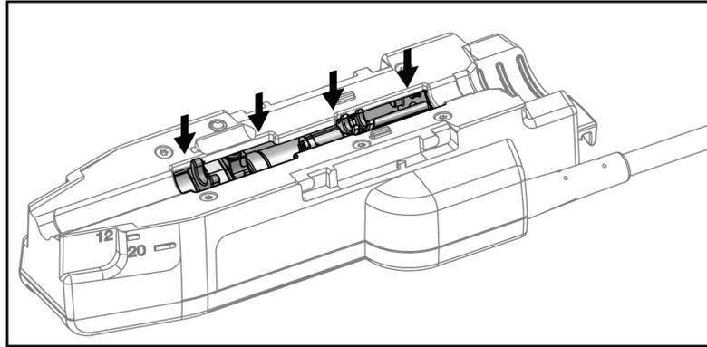
*Figura 8: Piezas metálicas del controlador de dispositivo*
