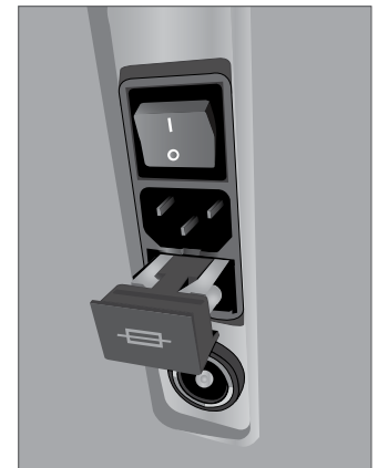
Plassering av sikring
