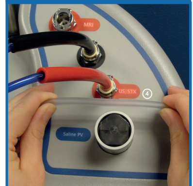
Figura 5: Conexión de la válvula de manguito de solución salina
